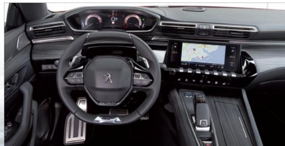
▶▶ El puesto de conducción Peugeot i-Cockpit permite personalizar la pantalla de la instrumentación, que al estar por encima del volante reúne, en la línea de visión de la carretera, todos los datos útiles para la conducción, incluida la novedosa visión nocturna.
