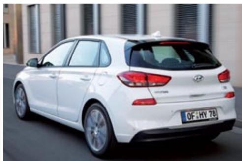
compacto de Hyundai es la mejora del equipamiento de conectividad —ahora se ofrece un equipo con pantalla de 8 pulgadas compatible con Android Auto y Apple Car Play— y la sustitución de los anteriores motores diésel por el nuevo 1.6 CRDi, que reduce el consumo y las emisiones de CO<sub>2</sub>, y está disponible con tres niveles de potencia —96, 116 y 136 CV— y dos tipos de cambio: manual y automático 7DCT.
