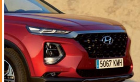
El frontal hereda la nueva parrilla en cascada. Y en la trasera destaca la ubicación de los intermitentes, justo por encima del paragolpes, en una posición que parece muy baja.
