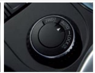
◀ El Kadjar puede contar con tres tipos de tracción: delantera, delantera con Extended Grip y total 4x4. En función del sistema, lleva un mando u otro.
