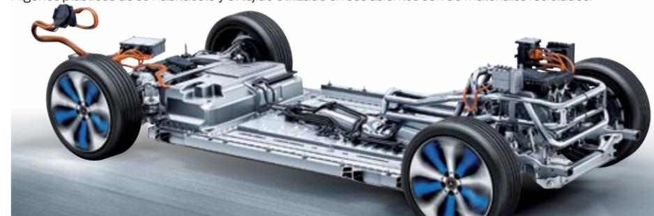
▲ El EQC usa la plataforma del GLC, pero actualizada para colocar sus baterías de 80 kWh. Ellas solas pesan 650 kilos.
