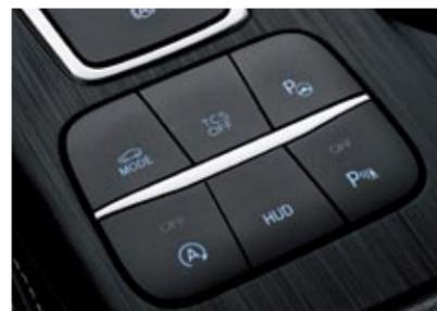
**ERGONOMÍA ESTUDIADA.** - En el nuevo Focus la ergonomía está bien estudiada. Por eso algunos de los principales interruptores se localizan a mano en la consola central, detrás del freno de estacionamiento. En la foto, la versión Titanium con los modos de conducción, el mando del Head-up display o la desconexión del control de tracción.
