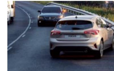
**FRENADO POSTCOLISIÓN.** El frenado postcolisión ayuda a reducir la probabilidad de sufrir una colisión secundaria en caso de accidente. Si el sistema detecta un accidente, activa el freno de emergencia de manera automática, lo que evita que el vehículo siga avanzando hacia el tráfico que viene en sentido contrario o hacia otros obstáculos.
