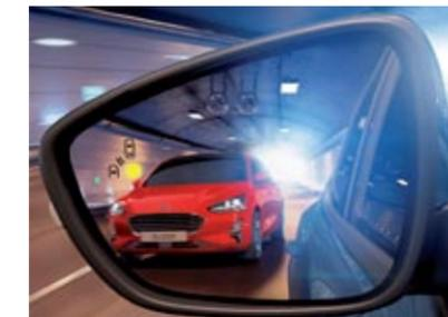
**ASISTENTE DE ÁNGULO MUERTO.** El Sistema de información de ángulos muertos utiliza sensores radar para ver vehículos que pueden quedar ocultos en los ángulos muertos. Están situados a ambos lados del nuevo Focus y avisan mediante una luz naranja que aparecerá en el espejo retrovisor lateral que corresponda.
