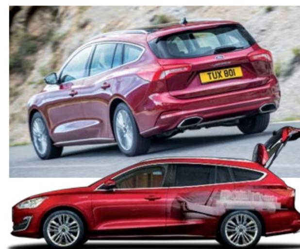
▶ El maletero del Focus Sportbreak cubica nada menos que 608 litros, que se pueden ampliar a 1.653 litros abatiendo los respaldos traseros.
