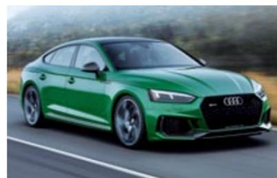
**AUDI RS 5 SPORTBACK.-** Con buen criterio, Audi combina su práctica carrocería Sportback –maletero de 480 litros ampliable a 1.300– al brío del RS 5, con su 2.9 TFSI V6 Biturbo de 450 CV y 61,2 mkg que le permite alcanzar 280 km/h. Tiene cambio Tiptronic de 8 marchas, tracción Quattro y rebaja la suspensión 7 milímetros respecto al S5.
