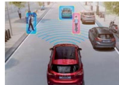
**ASISTENTE DE PRECOLISIÓN Y DETECCIÓN DE PEATONES.** Utiliza radar y cámara para analizar la carretera. Si detecta un riesgo de colisión con un vehículo, peatón o ciclista, el conductor recibirá un aviso. Y si no responde, el sistema puede aplicar toda la potencia de frenado para reducir la gravedad de algunas colisiones o, incluso, evitarlas.
