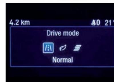
**MODOS DE CONDUCCIÓN.** - Los modos de conducción seleccionables incluyen diferentes tipos de respuesta al volante: Normal, Eco y Sport. Cada uno modifica la respuesta del acelerador, el tacto de la dirección e, incluso, el comportamiento del cambio de marcha –automático– en función del estilo de conducción.
