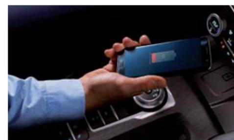
**CARGA INALÁMBRICA DEL SMARTPHONE.** - Los cables ya son historia, porque en la parte más adelantada de la consola central hay una bandeja que permite cargar el teléfono móvil de manera inalámbrica, de una forma más sencilla y práctica. Basta con 'posarlo' para que, una vez que lo reconozca, inicie la carga.
