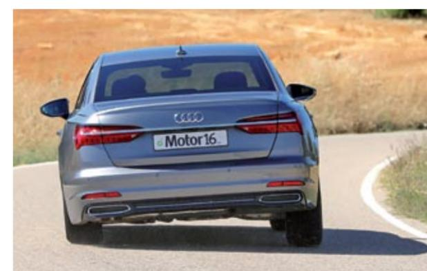
▲ En la imagen, el A6 50 TDI con la suspensión neumática opcional ajustada en el modo Comfort. De ahí la inclinación de la carrocería.
