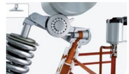
**DESACTIVACIÓN DE CILINDROS-** Tanto los motores 1.0 EcoBoost como los nuevos 1.5 EcoBoost se benefician de la desactivación temporal de un cilindro, maniobra que sucede en 14 milésimas de segundo. El sistema permite reducir los consumos notablemente en determinadas situaciones que no requieren de toda la potencia.
