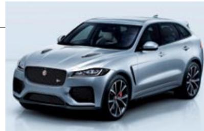
**JAGUAR F-PACE SVR.-** Cuesta 116.190 euros y equipa un V8 sobrealimentado por compresor que alcanza los 550 CV y 69,4 mkg, cifras que asociadas a su cambio automático de 8 marchas y a la tracción total se traducen en 283 km/h de velocidad punta y un paso de 0 a 100 km/h en 4,3 segundos. Maletero de 650 litros y gasto medio de 11,9 l/100 km.
