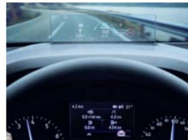
**HEAD-UP DISPLAY-** La pantalla junto al parabrisas proyecta la información del cuadro de mandos del vehículo en el campo de visión del conductor, para que pueda mantenerse informado sin tener que apartar la mirada de la carretera. La información puede personalizarse.
