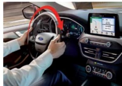
**ASISTENTE DE EMERGENCIA.** La dirección adaptativa con asistente de emergencia ayuda a esquivar vehículos más lentos, o detenidos, para evitar accidentes. El sistema utiliza un radar y una cámara para captar los vehículos lentos o detenidos, y ofrece mayor asistencia de dirección para ayudar a esquivar el vehículo si existe algún riesgo.
