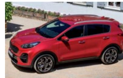
**KIA SPORTAGE.-** No hay mucho cambio de diseño –ópticas delanteras y traseras, parrilla frontal, difusor trasero, volante, pantalla central...– pero sí en la parte técnica, pues debuta el diésel 1.6 CRDi, en versiones de 115 y 136 CV, y el 2.0 Mild Hybrid, también diésel y con 185 CV, que ahorra un 7 por ciento con su hibridación ligera por batería de 48 voltios.
