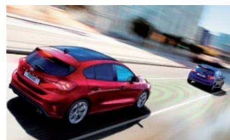
**FRENADO ACTIVO.** - Funciona cuando se circula a velocidades de más de 50 km/h. Utiliza un radar y advierte si detecta riesgo de colisión. Si no se reacciona, el sistema de frenado activo precarga los frenos y empieza a frenar para ayudar a bajar la velocidad. Cuando se circula a menos de 50 km/h, la parada urbana activa es completa.
