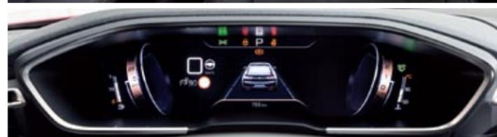
▲▶ La instrumentación elevada es una lámina digital de 12,3 pulgadas de alta resolución. Totalmente personalizable, ofrece seis modos de pantalla y muestra todos los datos útiles, incluida la visión nocturna.
