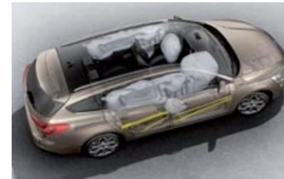
**AIRBAGS.** Además de los airbags delanteros para conductor y pasajero, los laterales protegen el tórax y se han diseñado para apartar al ocupante de la zona de impacto. Pueden elevar el brazo del ocupante para dejar más espacio entre él y la estructura que penetra en el interior. Y los airbags de cortina dan la máxima cobertura.
