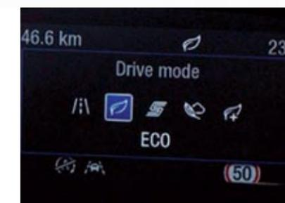
**FORD ECO MODE.** - El sistema evalúa constantemente la velocidad, el manejo del cambio y la asiduidad con la que se frena. Así como los niveles de anticipación y el número de recorridos a corto y largo plazo. Con estos datos, evalúa cómo afecta la forma de conducir respecto al consumo de combustible y actúa en consecuencia.
