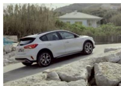
**ASISTENTE DE ARRANQUE EN PENDIENTE.** - Es una de las ayudas a la conducción más valoradas. Este asistente evita que el vehículo se desplace hacia atrás al detenernos en una pendiente. Para ello mantiene la presión de los frenos unos segundos mientras cambiamos el pie del pedal del freno al acelerador.
