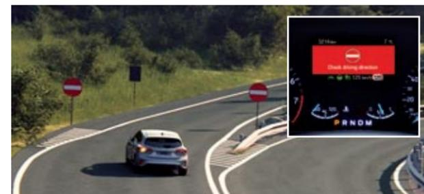
**ALERTA DE DIRECCIÓN CONTRARIA.** La Alerta de Dirección Contraria utiliza una cámara delantera y la información del sistema de navegación para detectar si se circula en sentido contrario. El sistema dispone de avisos visuales y sonoros que se activan si se avanza en dirección contraria, para que se pueda detener el coche y tomar las medidas oportunas.
