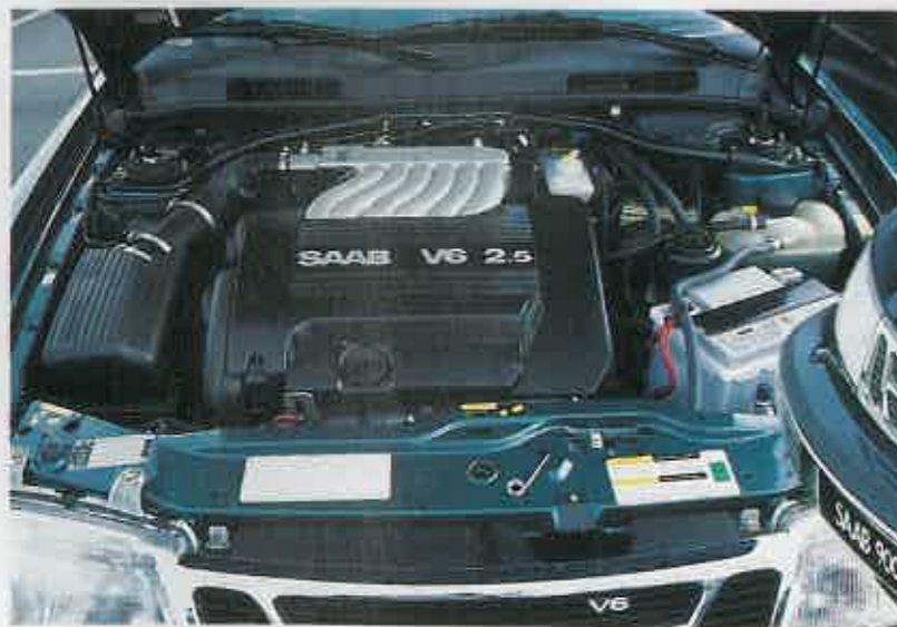
CUATRO MOTORES ENCABEZADOS POR UN V6 Además de los reputados motores de cuatro cilindros, dos atmosféricos y un turbo, el Saab estrena un V6 de 2,5 litros de origen GM; el mismo que lleva el Opel Vectra.
