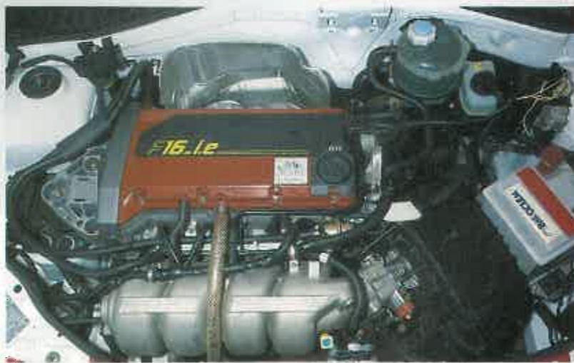
TODO ENERGÍA 1,7 litros, 16 válvulas y un concienzudo trabajo = 155 caballos de potencia.
