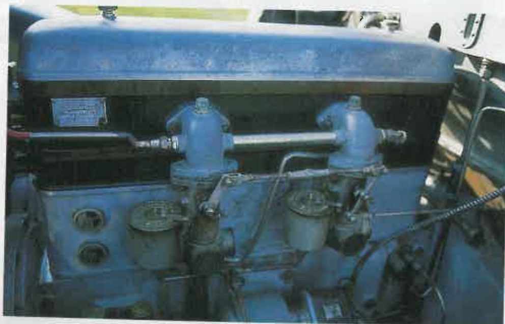
83 CABALLOS El RLSS Incorporaba cárter seco y desarrollaba una potencia de 83 caballos con 2.994 cc.
