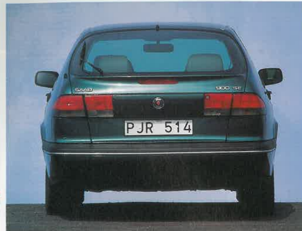
ELEVADA ZAGA A diferencia del anterior modelo, la zona trasera del nuevo 900 es mucho más elevada y compacta para conseguir una mejor aerodinámica.
