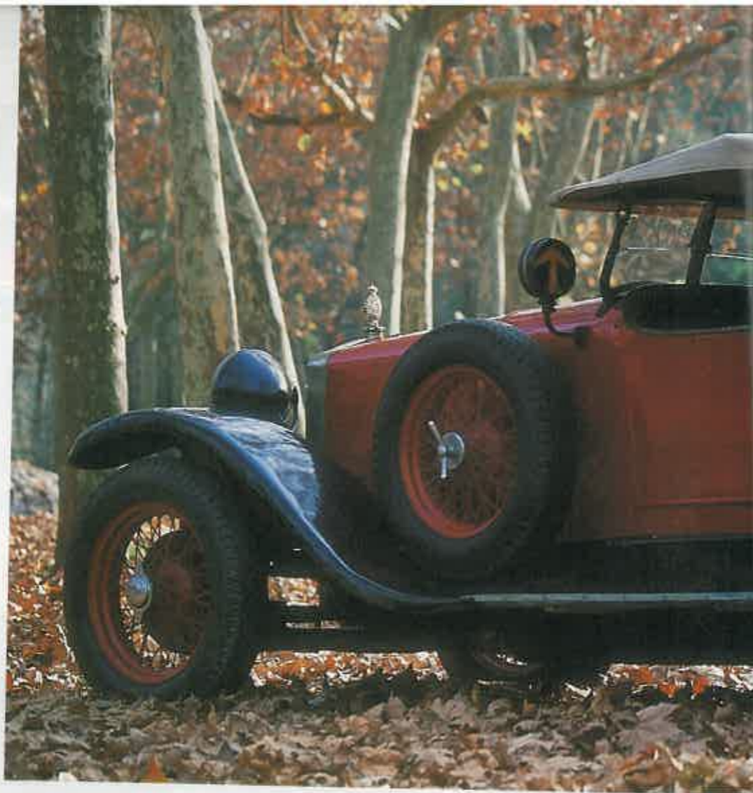
83 CABALLOS El RLSS Incorporaba cárter seco y desarrollaba una potencia de 83 caballos con 2.994 cc.
