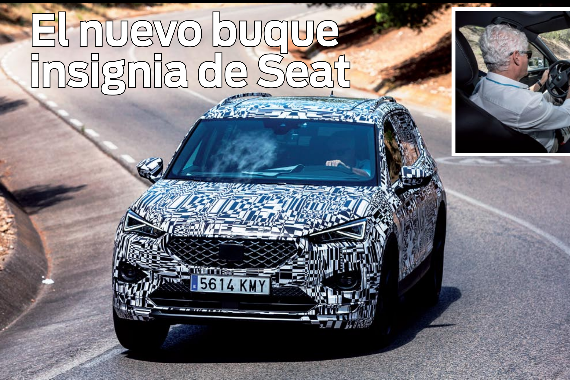
▲ En la primera toma de contacto con el Tarraco con traje de camuflaje tenemos carta blanca para hacer todo tipo de diabluras con el todocamino de 7 plazas español. En el campo y para compensar la mayor batalla, tiene más altura libre al suelo que el Ateca. Pero peores ángulos de ataque, ventral y de salida.
