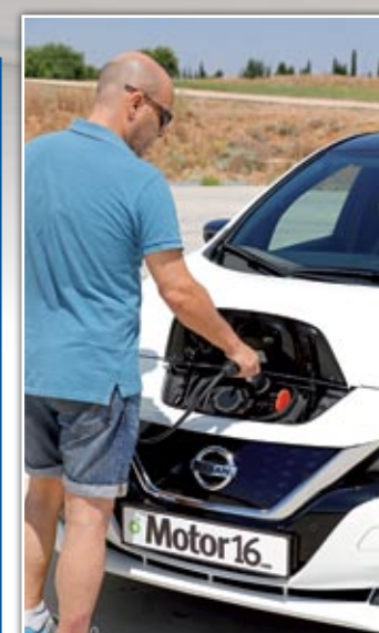
◀▶ Con el conector CHAdeMO a 50 kW la batería se carga al 80% en 40 minutos. En otros casos puede llegar a 21 horas...
