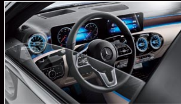
▲▼ El puesto de conducción más avanzado recurre a dos pantallas digitales de 10,25 pulgadas cada una. El coeficiente aerodinámico es de récord.
