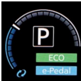
◀▶ Con la nueva función e-Pedal al levantar el pie de acelerador el vehículo frena con una intensidad de 0,2 G. No es necesario pisar el pedal del freno.
