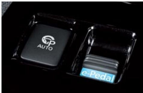
◀▶ Con la nueva función e-Pedal al levantar el pie de acelerador el vehículo frena con una intensidad de 0,2 G. No es necesario pisar el pedal del freno.
