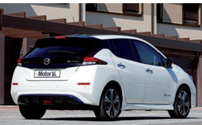
◀▶ Con la nueva función e-Pedal al levantar el pie de acelerador el vehículo frena con una intensidad de 0,2 G. No es necesario pisar el pedal del freno.
