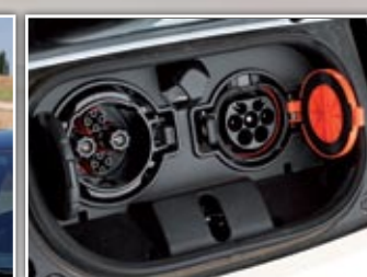
◀▶ Con el conector CHAdeMO a 50 kW la batería se carga al 80% en 40 minutos. En otros casos puede llegar a 21 horas...
