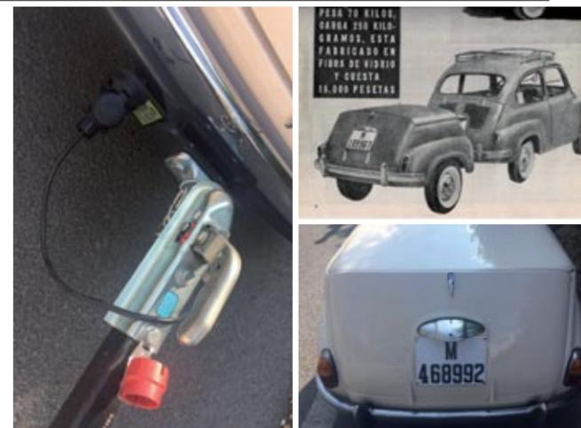
▶ Recurriendo a la estructura de un remolque comercial para no tener problemas de homologación, el remolque del 600 se ha replicado empleando un mes de trabajo y fabricándolo en fibra.
