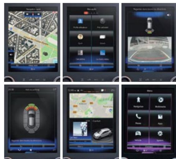
▲ La pantalla táctil vertical de 8,7 pulgadas del asistente R-LINK 2 nos brinda buena parte de la información del vehículo. Se maneja como una tablet, de manera rápida e intuitiva.
