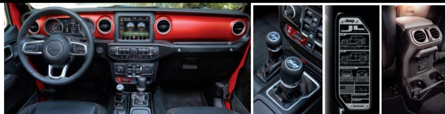
▲ El diseño interior mantiene su esencia, pero han mejorado los materiales y la ergonomía. Ahora hay pantallas táctiles de 5, 7 y 8,4 pulgadas, con conectividad Uconnect. Tanto los dos como los cuatro puertas tienen salidas de ventilación trasera. Ahora sólo se ofrece cambio automático.
