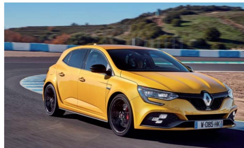
▲▲ La imagen del Mégane R.S. resulta más agresiva debido a los nuevos paragolpes, el alerón y difusor traseros, el ensanchamiento de las vías o las llantas de hasta 19 pulgadas con frenos Brembo.
