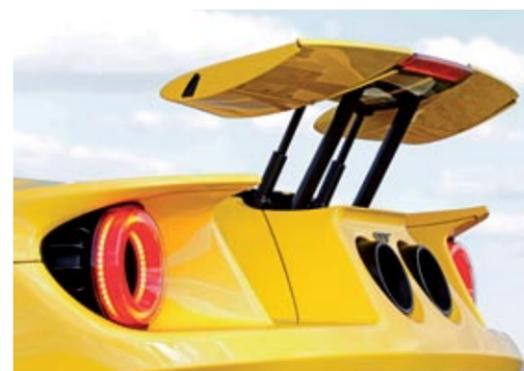
▲▶ El alerón sube y se repliega instantáneamente, y sin suavidad alguna. Y en función del modo de conducción, el alerón sale a una velocidad o a otra... o no sale. Además, al frenar con fuerza se pone vertical.
