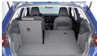
▲ El maletero se reduce, aunque presume de 282 litros y es fácilmente ampliable.
