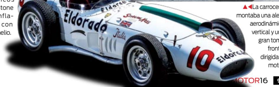
▶▶ La carrocería montaba una aleta aerodinámica vertical y una gran toma frontal dirigida al motor.
