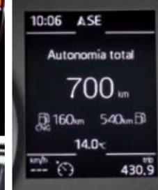
▲ Cuando funciona con gas, lo recuerda el testigo verde 'GNC'. Y el dato sobre autonomía es doble: con gasolina y con gas.
