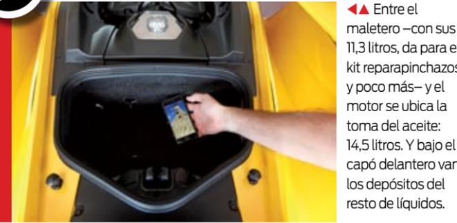
◀ Entre el maletero –con sus 11,3 litros, da para el kit reparapinchazos y poco más– y el motor se ubica la toma del aceite: 14,5 litros. Y bajo el capó delantero van los depósitos del resto de líquidos.
