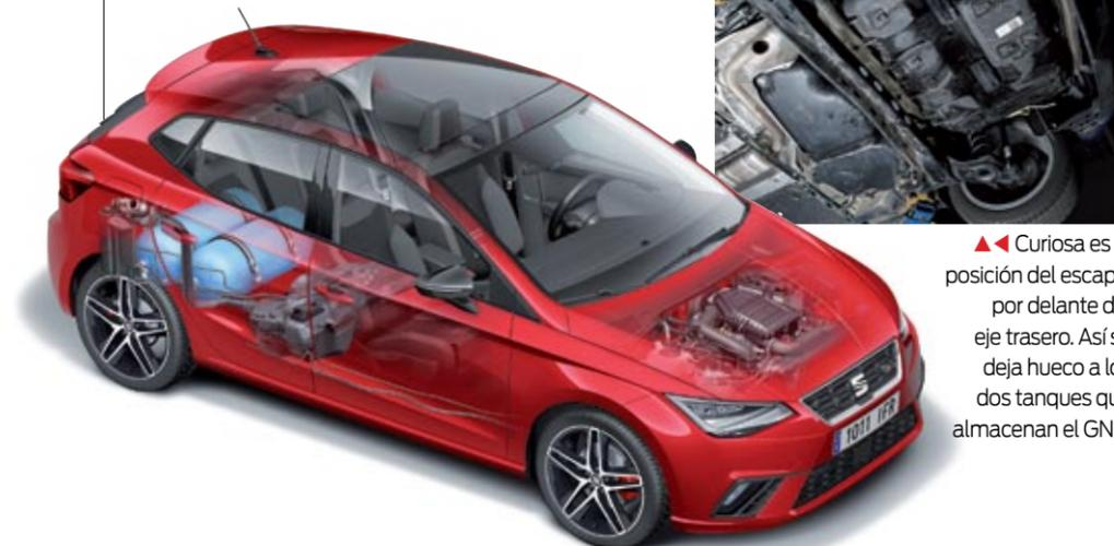
▲ Curiosa es la posición del escape, por delante del eje trasero. Así se deja hueco a los dos tanques que almacenan el GNC.
