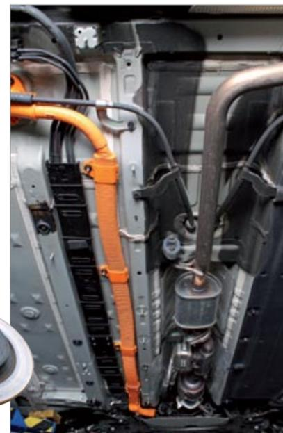
◀ Una vez retirado el panel atornillado que protege los bajos, comprobamos las sujeciones del cableado de alta tensión. La distribución de los diferentes elementos es pulcra y ordenada.
