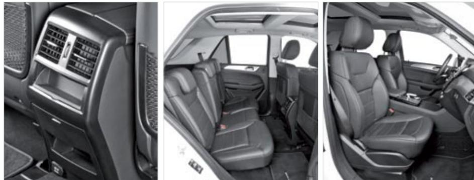
▶▶ El GLE –arriba– destaca por su cota de altura en las plazas traseras. Y por la casi total ausencia de túnel central, que sólo mide 6 centímetros de altura, lo que facilita el acomodo de un quinto ocupante. Los respaldos del asiento trasero se reclinan en varias posiciones. En el Velar –abajo–, los asientos vienen de serie con 10 movimientos y función de memoria en el del conductor. El espacio es bueno, pero sin la holgura de sus rivales.
