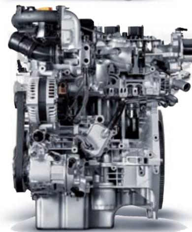
▲ En la foto superior, el nuevo motor de tres cilindros 1.0 GSE T3, que rinde 120 CV. Debajo, el 1.3 GSE T4, que ofrecerá dos niveles de potencia: 150 y 180 caballos.
