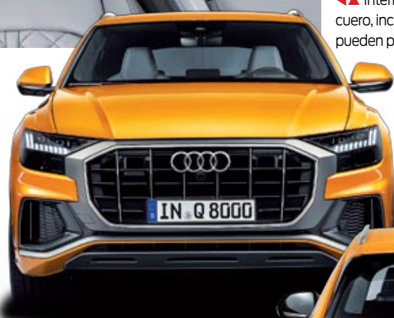
▶ El Cx es de 0,34 y la altura libre al suelo, de 22 centímetros; aunque con la suspensión adaptativa puede alcanzar los 25,4 centímetros. La versión 3.0 TDI pesa 2.145 kilos.
