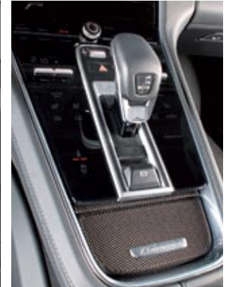
▲ El cambio automático PDK de 8 velocidades se puede manejar desde las levas del volante. Es rápido y eficaz.
