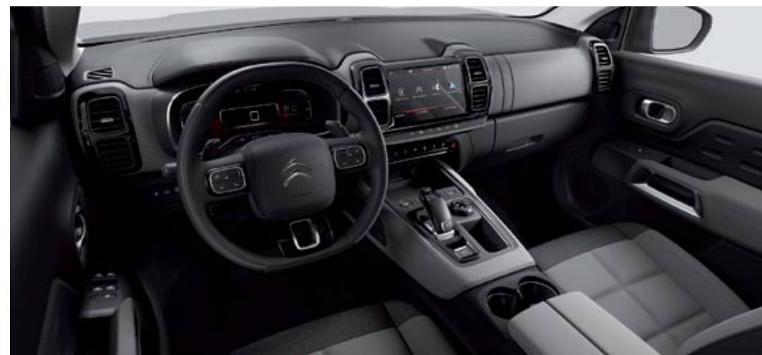
▲ A diferencia de lo que ocurre en el Peugeot 3008, la instrumentación va en la posición tradicional, pero es también una pantalla configurable –12,3 pulgadas– con tres diseños. La pantalla central táctil es de 8 pulgadas.
