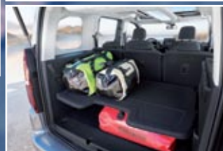
◀ Abatiendo el respaldo del copiloto, la longitud de carga es de 305 centímetros.
