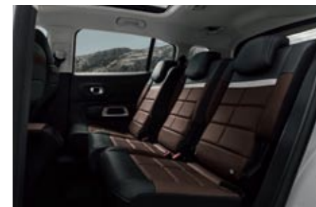
◀ A diferencia del C5 Aircross que se vende en China, el fabricado en Francia tendrá una segunda fila formada por tres butacas, correderas y plegables por separado.
