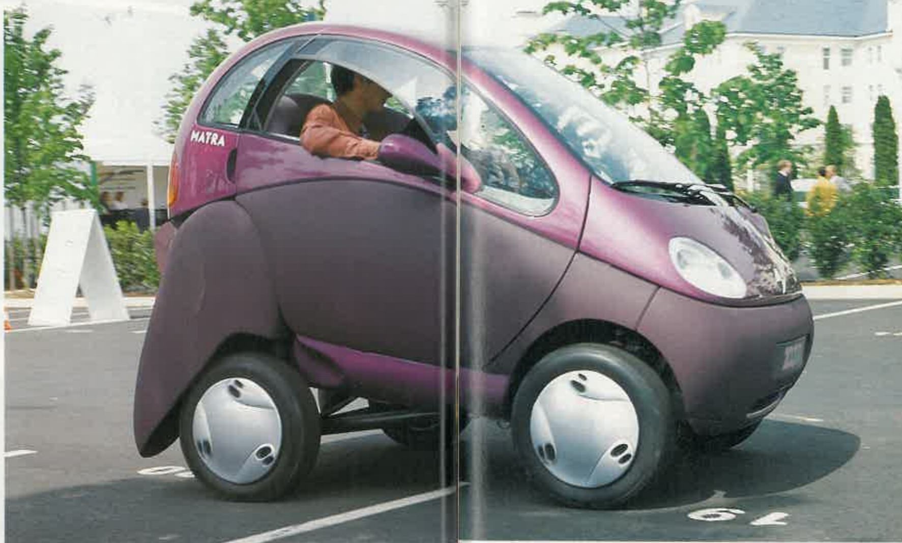
Y ENCIMA CORRE El Zoom alcanza los 120 kilómetros por hora con una aceleración sorprendente. Se encoge para aparcar y sus baterías de níquel-cadmio duran hasta 260 km.
