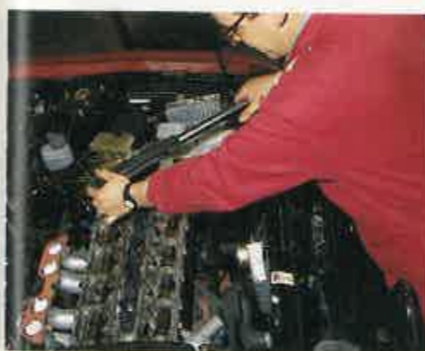
VERIFICACIÓN FINAL Se desmontaron las culatas de los tres coches ganadores para analizar su estado después de la prueba.
