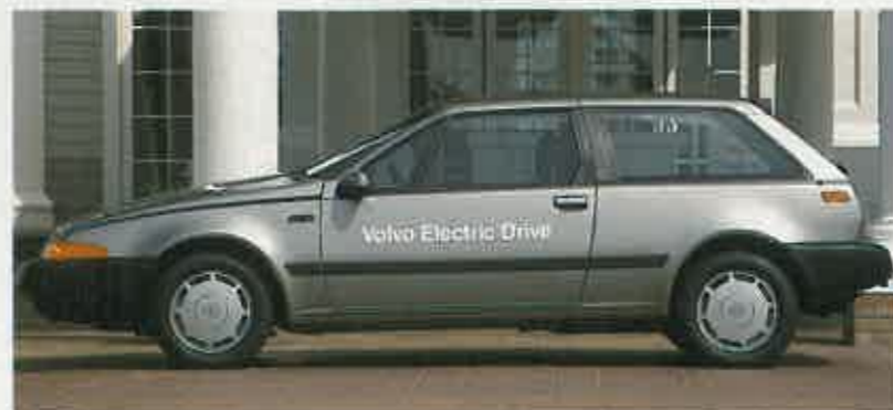
VOLVO 480 ES ELÉCTRICO En este caso se sacrifican las plazas traseras para alojar las baterías. Estas pueden recargarse en menos de 45 minutos mediante el sistema Volvo.
