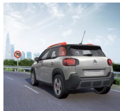
▲ El sistema de reconocimiento de señales de tráfico resulta de gran ayuda para evitar sorpresas con los radares. Una cámara frontal lee los límites de velocidad, y el asistente es capaz de ajustar la velocidad del vehículo a ese valor para evitar descuidos.
