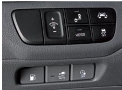
▶▶ A la izquierda del volante, sobre los botones vinculados a la recarga de gasolina y de electricidad, va el del sistema VESS (Virtual Engine Sound System), que permite generar ruido en modo eléctrico para que nos oigan.
