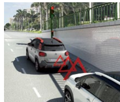
▲ Gracias al asistente de salida en pendiente Hill Assist, el vehículo permanecerá inmóvil unos instantes, evitando que se desplace hacia atrás. Este sistema, que se ofrece de serie en toda la gama, contribuye a incrementar la seguridad y la eficiencia.
