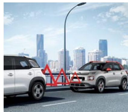
▼ El Active Safety Brake consta de una cámara multifunción frontal que avisa, de manera sonora y visual, en caso de riesgo de colisión o atropello. Este asistente está activo entre 5 y 85 km/h, y frena automáticamente el vehículo si el conductor no reacciona.
