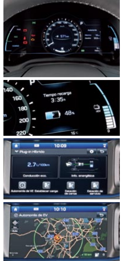
▲ La instrumentación ofrece una variada información, como gasto por tramos, flujos de energía, autonomía en modos híbrido y eléctrico. O el radio de acción en un mapa.
