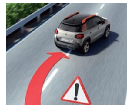
▼ La alerta de cambio involuntario de carril avisa mediante una advertencia sonora y luminosa para que recuperemos la trayectoria. Se activa a partir de los 60 km/h, siempre y cuando no hayamos accionado la palanca de la intermitencia antes de rebasar la línea.
