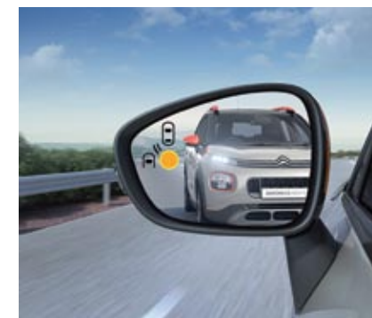
▲ El asistente de vigilancia del ángulo muerto –el campo que no llegan a recoger los retrovisores exteriores– es de suma ayuda para evitar ‘sorpresas’. Un pictograma se ilumina sobre el espejo para avisarnos cuando detecta la presencia de un vehículo en esa zona.
