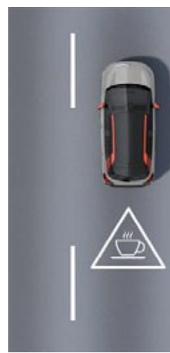
▶ La alerta de atención del conductor es un asistente que evalúa el comportamiento al volante. Si no es el adecuado, y tras rodar dos horas a más de 70 km/h, nos avisará con una señal que nos recomienda realizar una parada para descansar.
