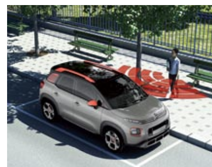
▲ Mediante la función de acceso y arranque manos libres, el vehículo reconocerá la llave al aproximarnos a él y desbloqueará las puertas para facilitarnos el acceso. Y con sólo apretar un botón encenderá el motor, sin necesidad de que saquemos la llave del bolsillo.
