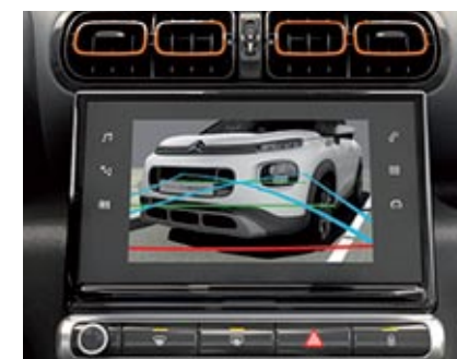
▲ La cámara de visión trasera 180 grados Top Rear Vision facilita las cosas en las maniobras marcha atrás. Las imágenes se reflejan en la pantalla táctil de 7 pulgadas del salpicadero, que también nos muestra referencias en color que indican la trayectoria para aparcarse.
