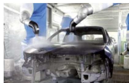
▲ La cadena de montaje del C4 Cactus tiene ahora 319 robots, y cada coche totaliza 4.096 puntos de soldadura. La fábrica trabaja en dos turnos de 8 horas, y cada uno debe producir 225 unidades, aunque la cadencia está pensada para que, si todo va perfecto, salgan dos o tres coches más por turno.
