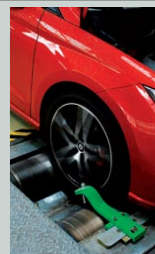
▶▶ Los técnicos del Banco de Potencia de Bosch, preparándolo todo para realizar la prueba en la que se averigua la potencia real que rinde el motor de cada coche probado, que suele evolucionar con el paso de los kilómetros. En este caso, a mejor.
