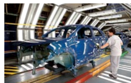
▲ Las carrocerías –foto grande– ya no discurren por una cadena clásica 'de foso', sino montadas sobre carros autónomos, que circulan o se detienen automáticamente. Y cada proceso ha sido optimizado: por ejemplo, los paragolpes delantero y trasero se acercan ahora a la cadena en un solo carro.
