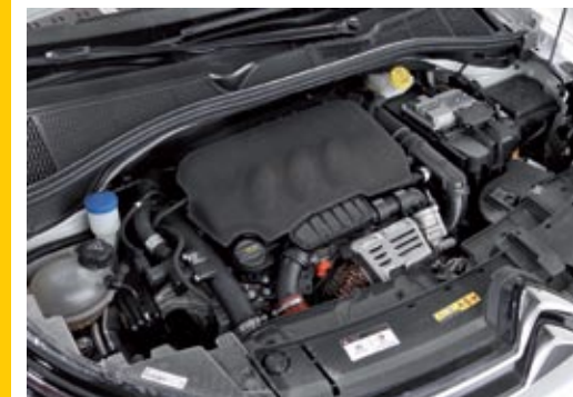
▲ El motor está muy bien insonorizado. Es un tres cilindros de 110 caballos que sorprende por prestaciones y consumos.
