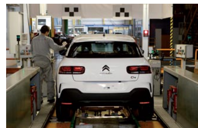
▲ Tras 25 horas, y después de cubrir 5,4 kilómetros por la cadena, llega a la zona final de Acabado. Y el motor se arranca con el C4 sobre rodillos.
