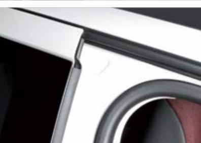
▲▲ Se ha aumentado el grosor de las gomas y de las juntas para mejorar el aislamiento y la insonorización. Y se nota mucho.
