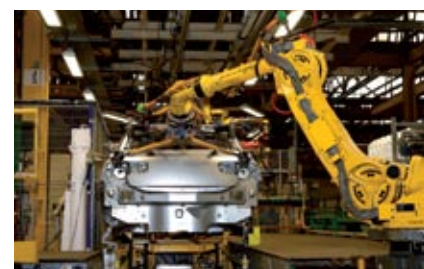
▲ La cadena de montaje del C4 Cactus tiene ahora 319 robots, y cada coche totaliza 4.096 puntos de soldadura. La fábrica trabaja en dos turnos de 8 horas, y cada uno debe producir 225 unidades, aunque la cadencia está pensada para que, si todo va perfecto, salgan dos o tres coches más por turno.
