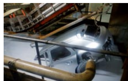
▲ La cadena de montaje del C4 Cactus tiene ahora 319 robots, y cada coche totaliza 4.096 puntos de soldadura. La fábrica trabaja en dos turnos de 8 horas, y cada uno debe producir 225 unidades, aunque la cadencia está pensada para que, si todo va perfecto, salgan dos o tres coches más por turno.
