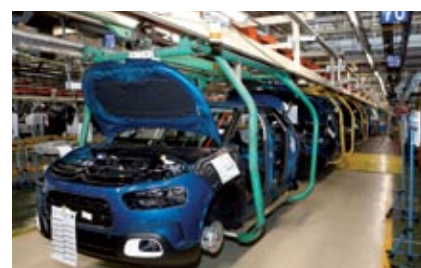
▲ Las carrocerías –foto grande– ya no discurren por una cadena clásica 'de foso', sino montadas sobre carros autónomos, que circulan o se detienen automáticamente. Y cada proceso ha sido optimizado: por ejemplo, los paragolpes delantero y trasero se acercan ahora a la cadena en un solo carro.
