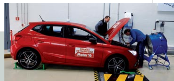
▶▶ Los técnicos del Banco de Potencia de Bosch, preparándolo todo para realizar la prueba en la que se averigua la potencia real que rinde el motor de cada coche probado, que suele evolucionar con el paso de los kilómetros. En este caso, a mejor.
