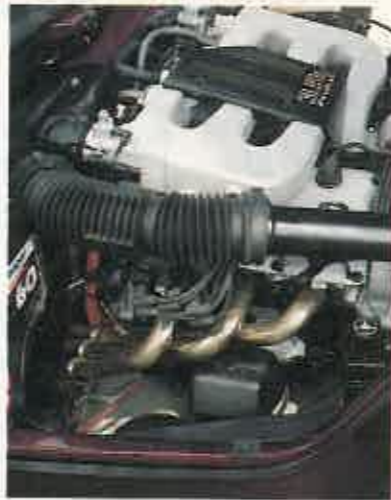
MOTOR AMERICANO El Prowler es movido por un potente V6 de 3,5 litros de capacidad.
