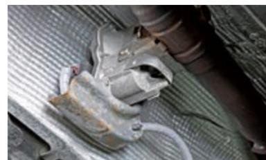
▲ Pegado al colector vemos el actuador de control eléctrico de la mariposa de escape.
