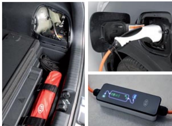
▲ La batería de 12V va en un lateral del maletero, y bajo el suelo hay un doble fondo donde cabe el cable de carga o los triángulos. En un enchufe normal, la batería principal se llena en cuatro horas y media.
