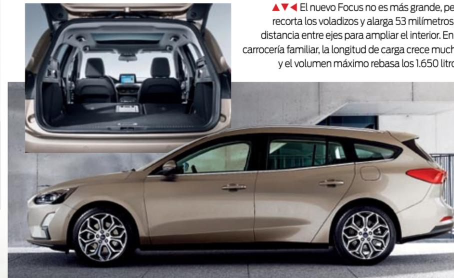
▲▼▲ El nuevo Focus no es más grande, pero recorta los voladizos y alarga 53 milímetros la distancia entre ejes para ampliar el interior. En la carrocería familiar, la longitud de carga crece mucho, y el volumen máximo rebasa los 1.650 litros.
