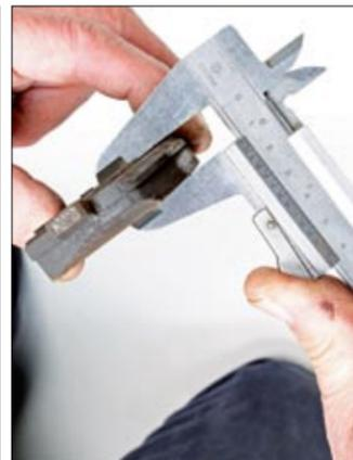
▶ Las pastillas de freno han sufrido el desgaste normal de un vehículo de estas características. Han perdido sólo 2,5 mm de su grosor, y a ese ritmo le quedaría material suficiente como para recorrer otros 40.000 kilómetros.
