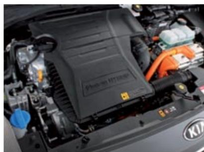
▶▶ El motor de gasolina es el mismo que en el Niro HEV de mecánica híbrida convencional, pero el eléctrico del PHEV rinde 44,5 kW, que son 12,5 más. El interior es amplio y está bien acabado, y el confort general es elevado.
