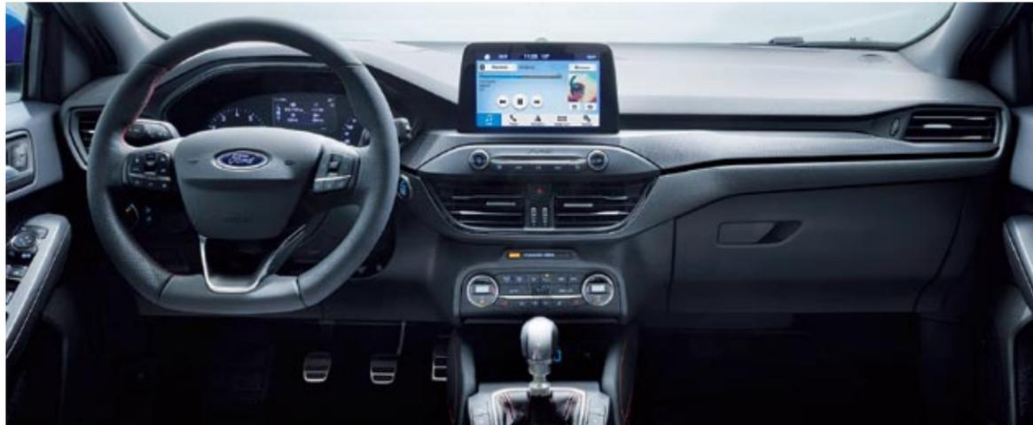
◀ Una pantalla táctil de 8 pulgadas preside el tablero, y el sistema Sync3 permite controlar audio, navegación, climatización y los 'smartphone' conectados por órdenes de voz. El cambio automático de 8 marchas, con rueda selectora, estará disponible con los EcoBoost de 125 y 150 CV, y EcoBlue 120 y 150.
