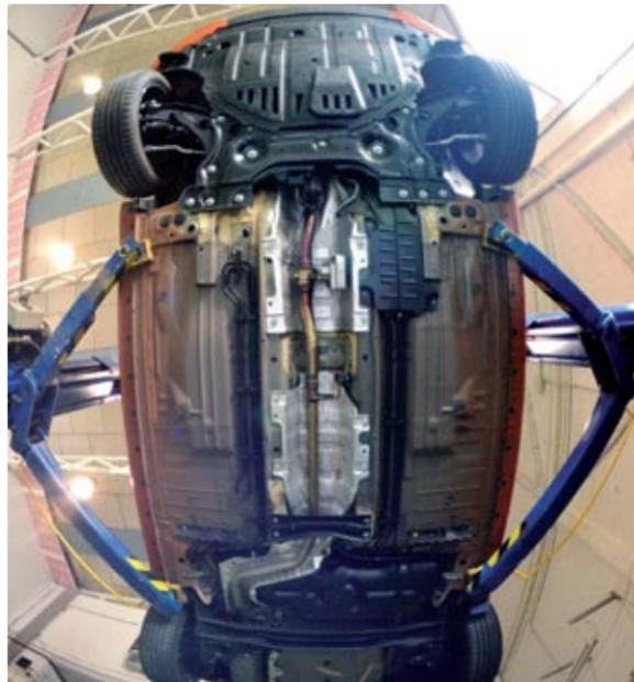
▲ En los bajos del Micra sorprende el gran túnel reservado para la línea de escape, supeditado sin duda al espacio necesario para integrar el actuador de control eléctrico de la mariposa de escape.
