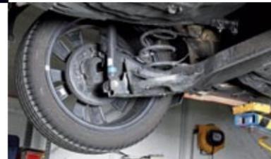
▲ En esta nueva plataforma CMF-B que estrena el Micra, el eje torsional trasero ofrece un nuevo diseño.
