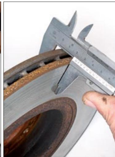
◀ Entre el principio -foto de la izquierda- y el final de la prueba -foto de la derecha-, con el odómetro marcando 25.000 kilómetros, los discos ventilados de los frenos delanteros no habían experimentado nada de desgaste, señal de que la calidad de los materiales es muy buena y de que las pastillas han realizado su labor adecuadamente.
