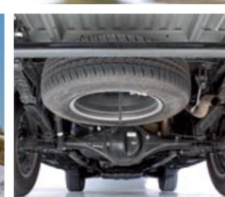
▶ La ubicación de los amortiguadores traseros es curiosa: el izquierdo va por detrás del eje y el otro por delante.
