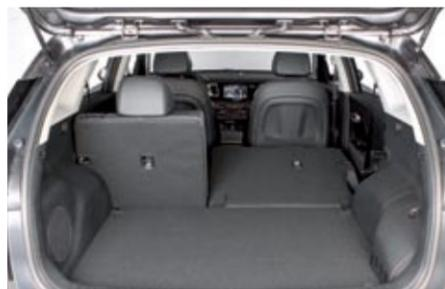
◀ El maletero, de 427 litros en el Niro HEV, se reduce aquí a 324 litros por la batería principal del sistema PHEV, ubicada bajo el suelo de carga.
