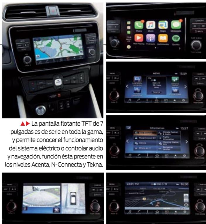
▶▶ La pantalla flotante TFT de 7 pulgadas es de serie en toda la gama, y permite conocer el funcionamiento del sistema eléctrico o controlar audio y navegación, función ésta presente en los niveles Acenta, N-Connecta y Tekna.
