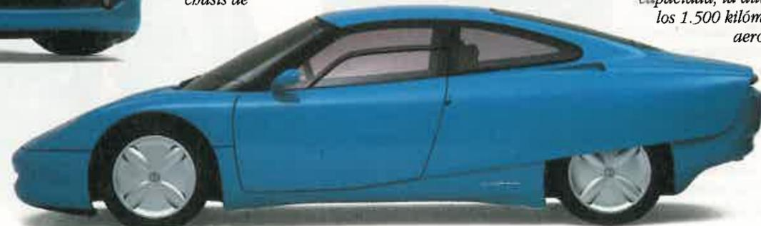
ha sido importante y destaca un coeficiente de penetración de sólo 0,19. La carrocería tiene una longitud de casi cuatro metros y el peso es de 730 kilos.
