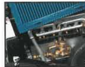
Bajo el capó, el mítico motor Rolls-Royce de seis cilindros está detallado hasta en las dobles bujías.
