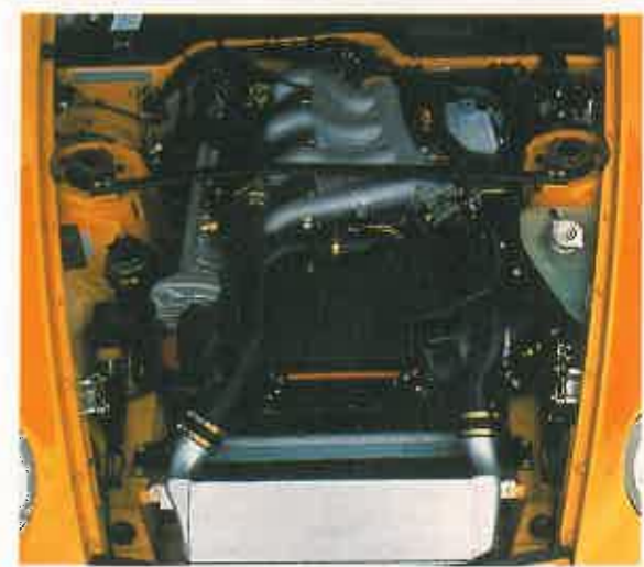
UN MOTOR DE MUCHOS QUILATES Arriba se observa la movilidad del alerón trasero. Abajo, el motor turbo que se emplea en el 968. Si su potencia es muy elevada (305 caballos), más lo es su par (51 mkg.).
