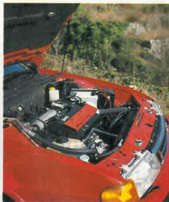
MÁS POTENCIA Y MÁS PAR MOTOR Equipado con el sistema Trionic, el motor del Aero tiene 225 caballos de potencia y un par motor muy mejorado.
