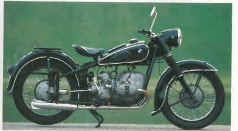
BMW R 51/3. En 1951 apareció este modelo con chasis tubular y la incorporación de la suspensión posterior. El motor tenía 500 cc. de cilindrada y mando de las marchas en el pie.
