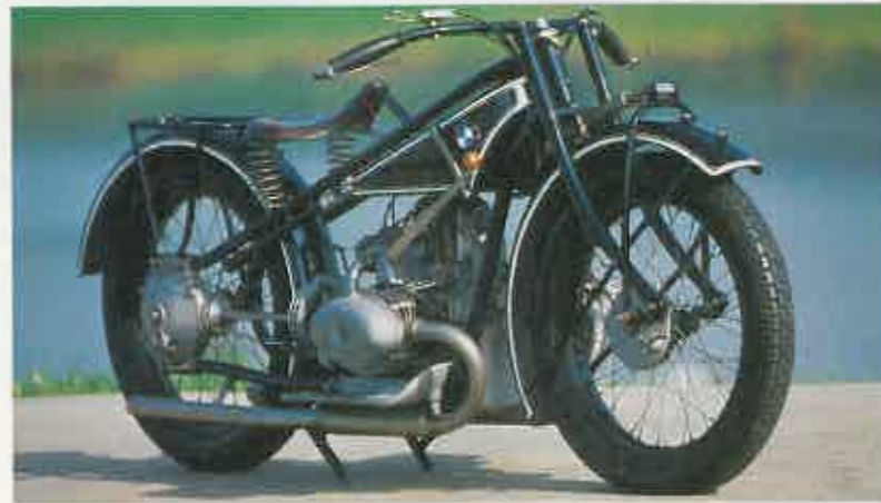
BMW R 47. En la última versión de este modelo realizado en 1928, se modificó el cambio y el sistema de suspensión delantero. Con 494 cc de cilindrada desarrollaba 18 caballos.
