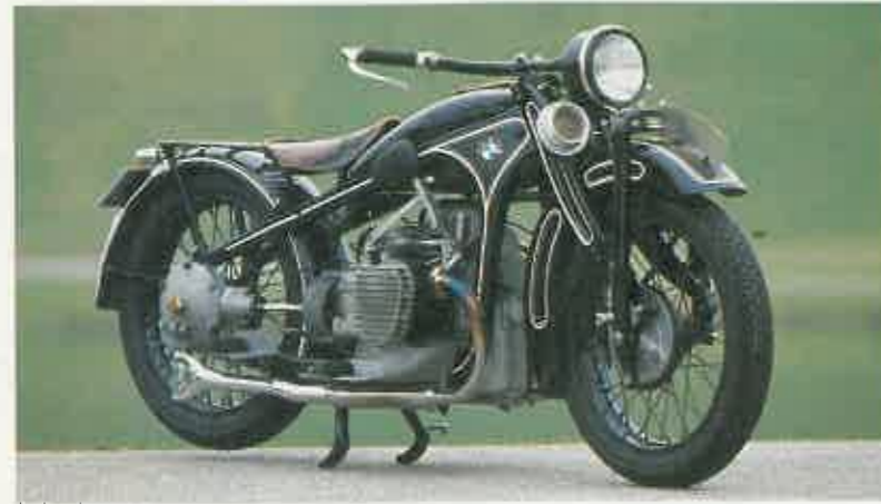
BMW R 11. Este modelo de talante turístico estaba equipado con un motor de 750 cc que le permitían alcanzar los 20 caballos de potencia en su última versión. Tenía el chasis de chapa estampada y el árbol de levas accionado por cadena.
