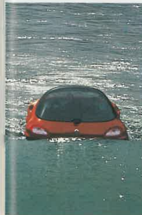
SOBRE EL AGUA Dos hidrojets se encargan de mover el Racoon en el agua, a cinco nudos.
