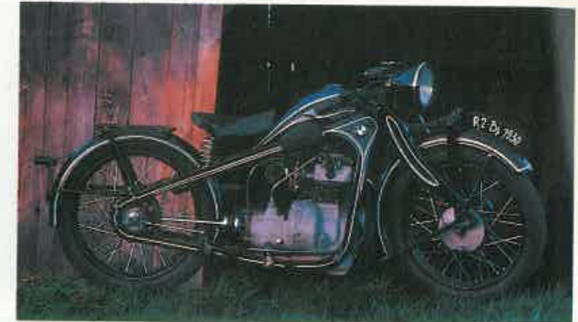
BMW R 2. Entre 1931 y 1936 se fabricó este modelo monocilíndrico con 200 cc. de cilindrada. En aquel entonces no precisaba permiso de conducir y destacaba por la ligereza de su chasis.
