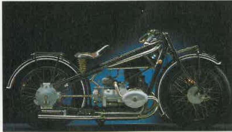
BMW R 47. En el motor de este modelo, construido en 1927, se adoptó el sistema de válvulas en cabeza y dos carburadores. A pesar de tener cilindros y culatas en acero destacaba por su carácter deportivo.
