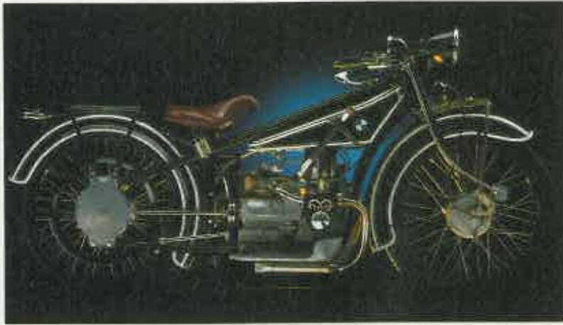
BMW R 32. Fue la primera moto equipada con motor de cilindros contrapuestos. Se fabricó desde 1923 a 1926, tenía 494 centímetros cúbicos de cilindrada y desarrollaba 8,5 CV.
