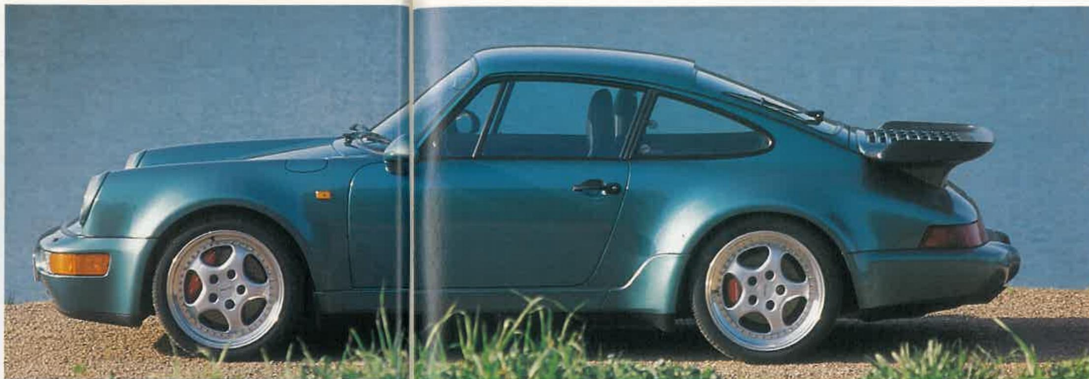
Porsche 911 Turbo. Las prestaciones que se logran con este nuevo motor ponen los pelos de punta: 280 kilómetros por hora de velocidad máxima, una aceleración de 0 a 100 km/h. en tan sólo 4,8 segundos y 23,3 segundos para hacer el kilómetro desde parado.
