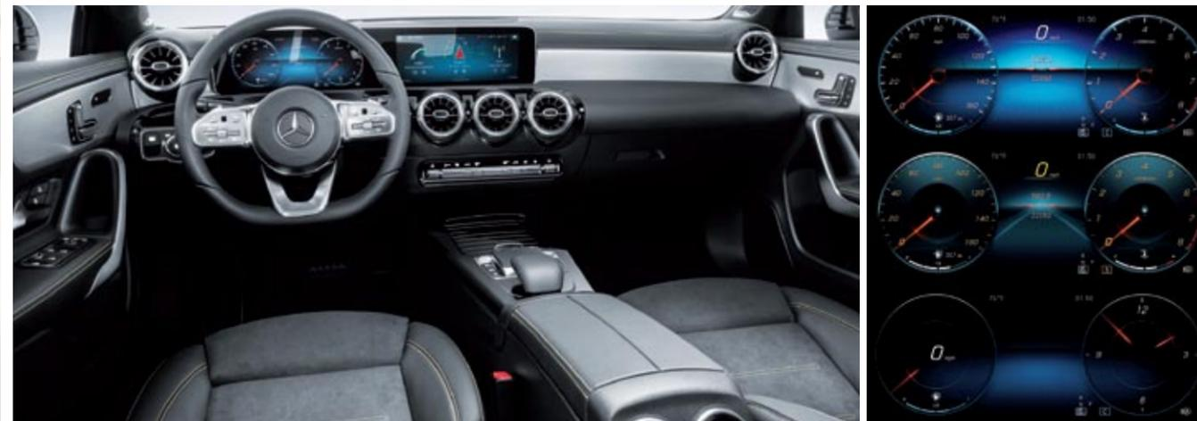
▲ Su velocímetro digital será completamente configurable, en tres modos diferentes. Las versiones con cambio 7G-DCT llevan el selector en la columna de la dirección para liberar espacio en la consola central. Todos sus mandos físicos están posicionados con mucha lógica.
