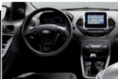
Entre las novedades, el SYNC 3 con pantalla de 6,5 pulgadas y los sensores de lluvia y luz.
