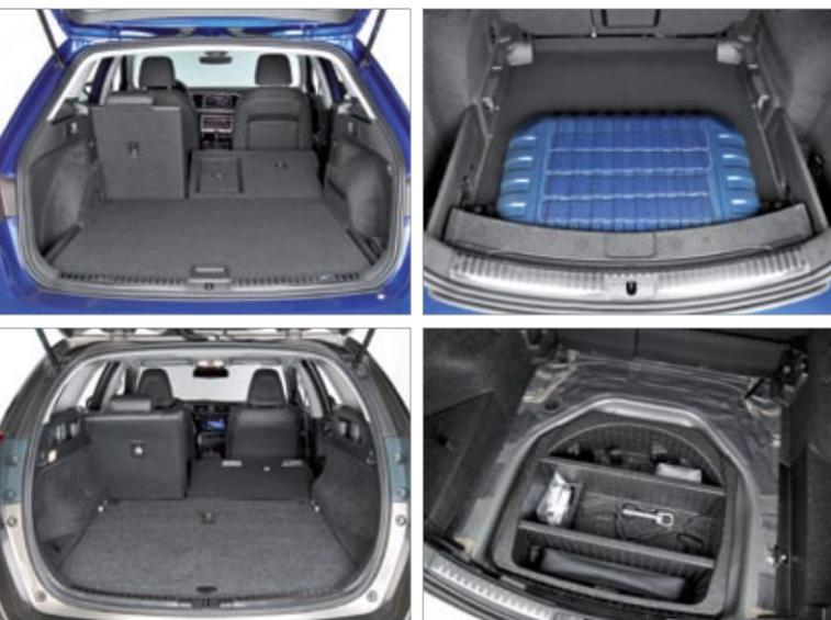
▶▶ En el Seat, los dos depósitos de gas –fotos superiores– están situados bajo el maletero, lo que le resta unos 100 litros; y se ve obligado a utilizar un kit de reparación en vez de una rueda de repuesto. Las baterías del Toyota –sobre estas líneas– van debajo del asiento trasero, por lo que tiene más maletero.
