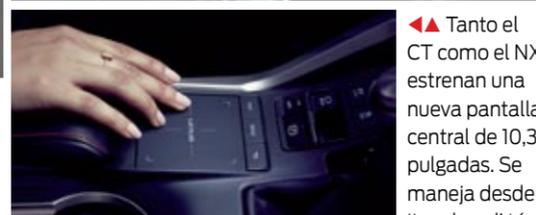
◀ Tanto el CT como el NX estrenan una nueva pantalla central de 10,3 pulgadas. Se maneja desde un 'touchpad' táctil junto a la palanca de cambios. Y la dotación de seguridad se multiplica con el Lexus Safety System+.
