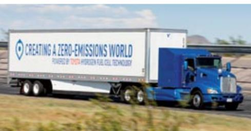
**PROJECT PORTAL.** - En los puertos californianos de Long Beach y Los Ángeles opera ya este camión de gran tonelaje -36.000 kilos de capacidad de carga- de Toyota, con 670 CV de potencia y dos grupos de pilas de combustible. Sin emitir gases, traslada mercancías desde las terminales hasta almacenes de distribución, en rutas diarias de unos 320 kilómetros.
