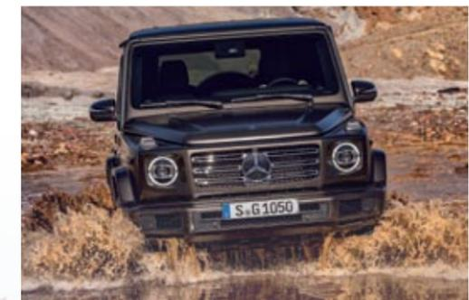
◀ Mejor en asfalto, pero también fuera de él. Por ejemplo, la altura al suelo es de 24,1 centímetros, puede subir rampas de 100 por cien y la profundidad de vadeo es de 70 centímetros. Además, aumentan los ángulos de ataque y salida.
