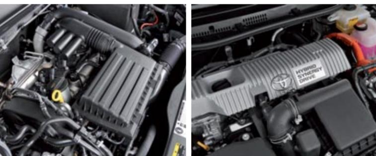
▶▶ A la izquierda, el motor de gasolina 1.4 TGI del León, que funciona tanto con gasolina como con gas natural comprimido. A la derecha, el 1.8 de 100 caballos del Toyota, que se combina con otro eléctrico de 82 caballos.
