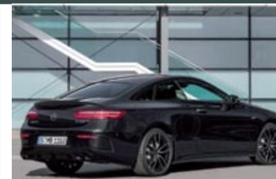
**MERCEDES E 53 AMG COUPÉ.-** La tercera versión '53' desvelada en Detroit por la firma alemana nace sobre la base de la carrocería coupé de la Clase E, y también tiene el seis cilindros híbrido con 435 CV de potencia, más los 16 kW del EQ Boost. Es común a todos el equipo de frenos, con cuatro discos ventilados de 370 mm delante y 360 mm detrás.
