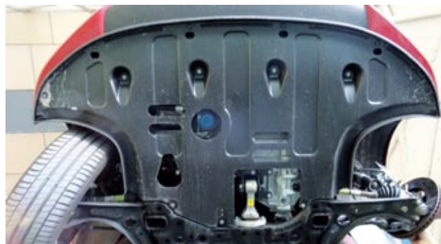
▲ Los bajos del i30 están perfectamente carenados. En la parte frontal destaca el 'antipar', un soporte del motor muy eficaz.
