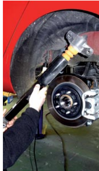
▲ A lo largo de esta prueba de 50.000 kilómetros los amortiguadores delanteros perdieron un 25 por ciento de su eficacia, y los traseros, un 19 por ciento. Algo que es lógico por cuestiones de reparto de pesos.
