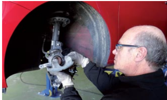
▲ Jose María Moreno desmontando la suspensión delantera tipo McPherson del i30. Los amortiguadores tuvieron un desgaste bueno.
