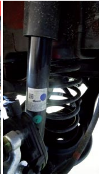
▲ A lo largo de esta prueba de 50.000 kilómetros los amortiguadores delanteros perdieron un 25 por ciento de su eficacia, y los traseros, un 19 por ciento. Algo que es lógico por cuestiones de reparto de pesos.
