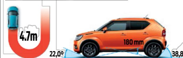
▶ Además de un mínimo radio de giro, el Ignis se beneficia en usos extremos de generosos ángulos 'off road' y de sus 18 centímetros de altura al suelo.
