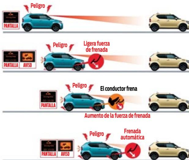
◀ Mediante sus dos cámaras, el Control Predictivo de Frenada detecta vehículos, peatones y carriles, ayudando a evitar colisiones y minimizar los daños a través de avisos y activando automáticamente los frenos.
