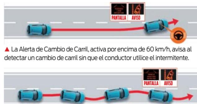
▲ La Alerta de Cambio de Carril, activa por encima de 60 km/h, avisa al detectar un cambio de carril sin que el conductor utilice el intermitente.
