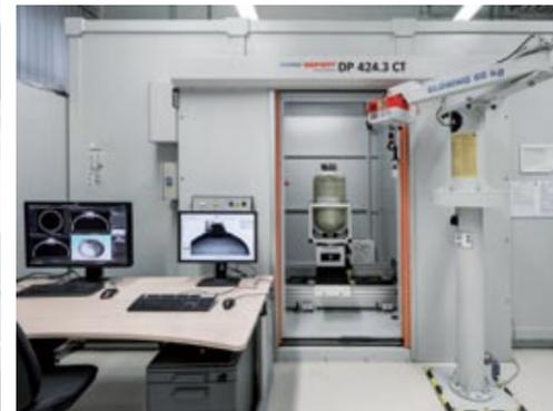
▲ Esta cámara de rayos X es un bunker: pesa 20 toneladas, tiene paredes de 30 centímetros de espesor y dentro se analiza de todo, como los tanques usados por las versiones g-tron, sin necesidad de destruirlos.
