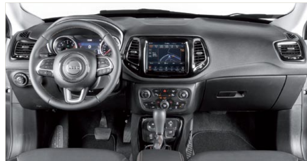
▶▶ La calidad del Jeep Compass está entre las mejores del segmento. La pantalla central puede ser de 5,0, 7,0 u 8,4 pulgadas; las dos últimas, con función táctil capacitiva. El cambio automático tiene 9 marchas.
