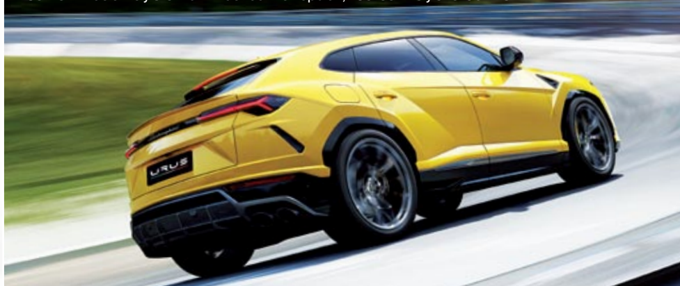
Equipa dirección en las cuatro ruedas, discos de freno carbocerámicos y neumáticos 285/45 R21 delante y 315/40 R21 detrás. Y en opción, 285/35 R23 y 325/30 R23.
