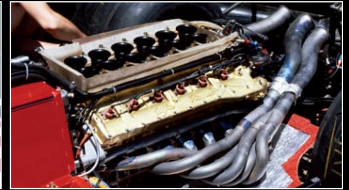
▲ El motor V12 usado en 1979 fue acusado de 'excesivamente sediento'. Era potente, aunque el Alfa Romeo 177 resultaba pesado y poco aerodinámico.
