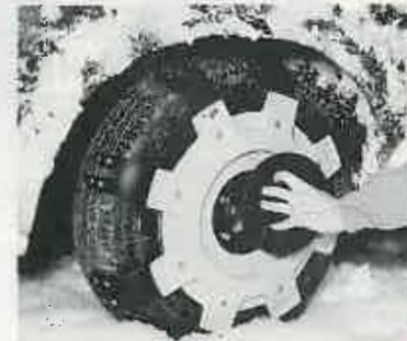
2- Colocar SPIKES SPIDER y fijar con un simple "clic" el disco de bloqueo.
