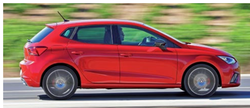
▲ Las versiones diésel con acabado FR reducen la altura de la carrocería 15 milímetros y endurecen el tarado de la suspensión para brindar un talante aún más deportivo.
