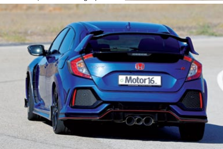
▲ El Civic Type R estrena un eje trasero multibrazo. Su escape central aspira aire para minimizar el ruido en modo Confort, y lo expulsa en Sport y +R.
