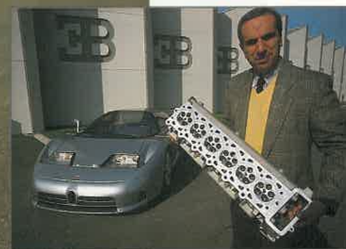
EL CREADOR Nicola Materazzi sostiene en sus manos una de las dos culatas del Supersport. Caracterizadas por la apertura desfasada de las válvulas.
