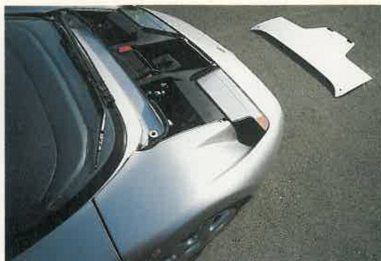
COMO DE CARRERAS Ambos capós se separan del coche al carecer de bisagras. Sus cierres son del más puro estilo «racing». La parte posterior es lo más personal y característico en este coche de ensueño.
