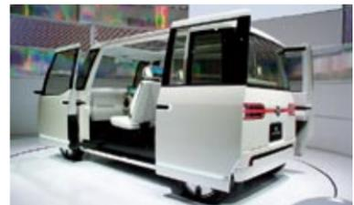
**DAIHATSU DN U-SPACE.** Un 'concept' próximo a la serie con cuatro plazas, un interior de suelo plano por el que se anda cómodamente y un motor de gasolina de 660 centímetros cúbicos. Mide 3,40 metros de largo por 1,48 de ancho y 1,75 de alto.
