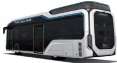
**TOYOTA FC BUS CONCEPT SORA.** - De cara a los JJ.OO. de 2020 la firma japonesa fabricará 100 unidades de este autobús urbano y eléctrico alimentado por hidrógeno. Tiene 79 plazas, dos motores de 154 CV y una autonomía de 200 kilómetros.
