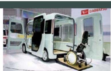
**DAIHATSU DN PRO CARGO.** Nuevo vehículo comercial biplaza de mecánica eléctrica que mide 340 centímetros de largo, 148 de ancho y 200 de alto. Presenta una altura interior de 1,60 metros y su suelo bajo facilita el acceso con silla de ruedas.
