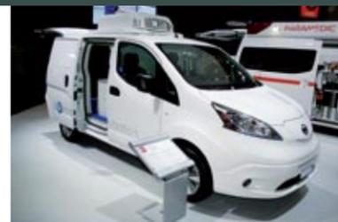
**NISSAN E-NV200 FRIDGE CONCEPT.** Sobre la furgoneta eléctrica e-NV200 se ha creado este prototipo, destinado al transporte refrigerado de mercancías por la ciudad. Porque a las baterías ion-litio normales, de 24 kWh de capacidad, suma otras—12 kWh—para alimentar el sistema refrigerante.
