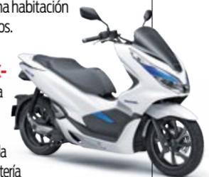
**HONDA PCX HYBRID.** Emplea un sistema híbrido de nuevo desarrollo ideado específicamente para motocicletas: una potente batería y un alternador que, además de proporcionar corriente y operar como sistema de arranque, asiste al motor de combustión. Llega en 2018.
