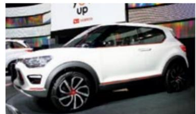
**DAIHATSU DN TREC.** Es la mínima expresión en el segmento SUV, pues mide 3,98 metros de largo por 1,70 de ancho y 1,60 de alto. Pero tiene cinco plazas y equipa llantas de 18 pulgadas. Puede elegirse entre un 1.2 híbrido y un 1.0 de gasolina con turbo.
