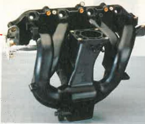
Bayer y otras firmas proveedoras, han trabajado para diseñar este componente en un molde de una pieza. El nuevo colector se fabrica en resina de nylon con refuerzos en fibra de vidrio. Es aproximadamente tres kilos y medio más ligero que el equivalente en aluminio y se prevén para el futuro
