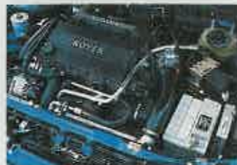
TURBO 16V Un motor para los Rover Coupé con cilindrada de dos litros.
