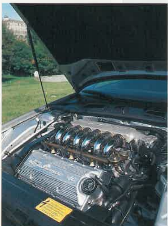
MÁS SOFISTICADOS Los motores «Super» de gasolina tienen 24 válvulas.
