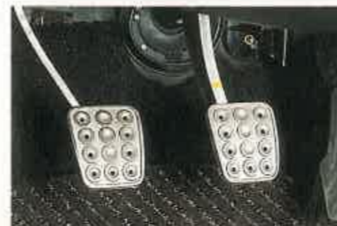
LIGEROS Y EFECTIVOS Los pedales son de aluminio. Su disposición permite hacer el «punta tacón».
