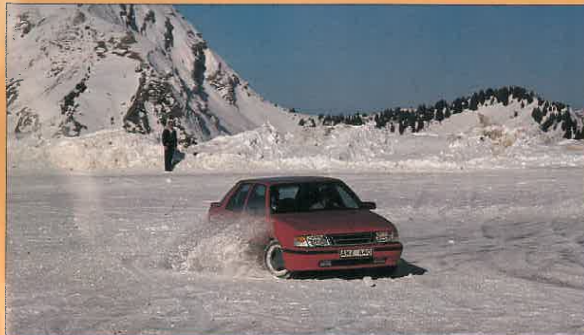
SE ACABARON LOS PATINAZOS Saab equipa de serie al 9000 CDT con el sistema TCS, que evita que se produzcan pérdidas de tracción. Este mecanismo es perfectamente compatible con el ABS.
