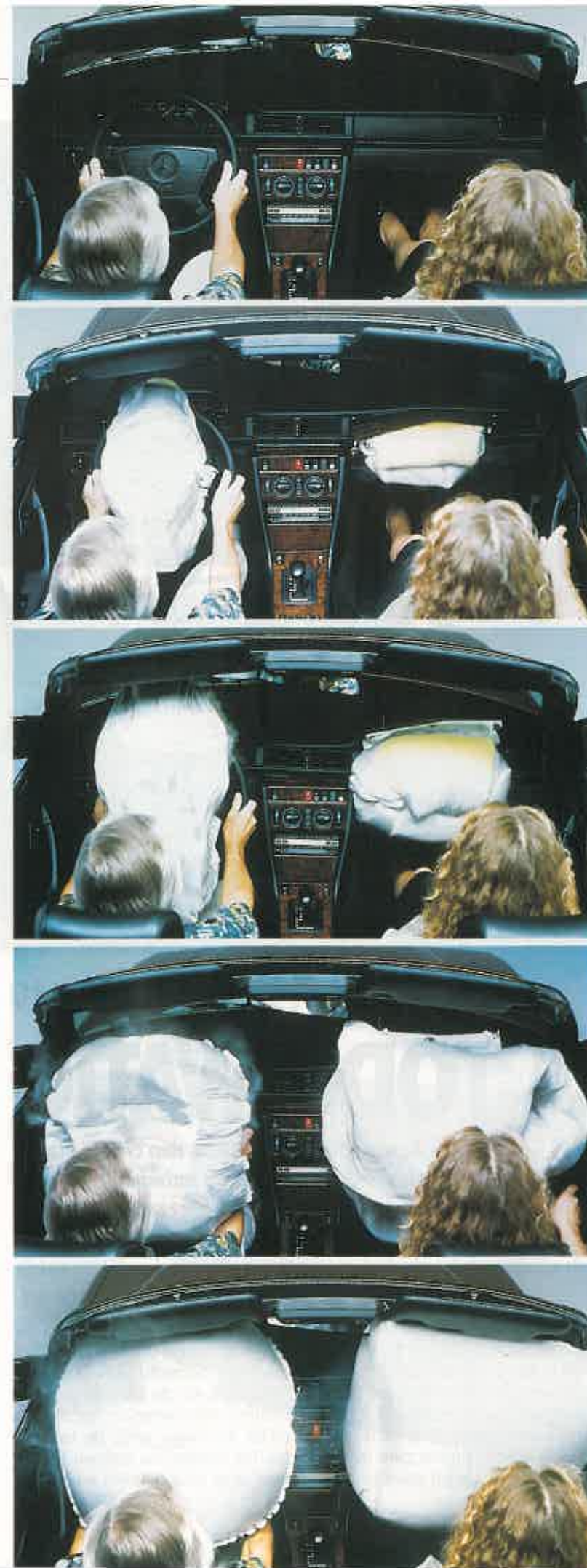
PROTECCIÓN ASEGURADA En una mínima fracción de segundo, y antes de que los ocupantes puedan sufrir las consecuencias del choque, la bolsa de aire se abre y evita que el conductor y el acompañante se lesionen con el volante o el parabrisas.
