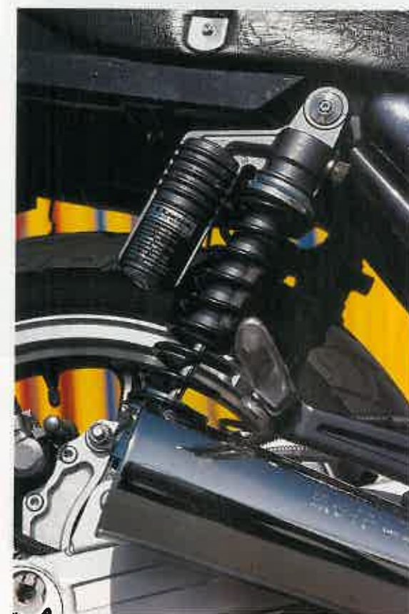
ESTILO CLÁSICO Suspensión trasera con doble amortiguador regulable.
