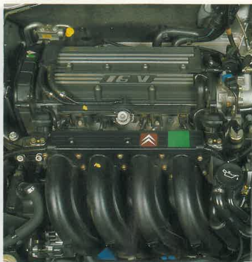
EL MÁS POTENTE DE GAMA El motor del nuevo ZX 16V, con culata de cuatro válvulas por cilindro y 155 caballos de potencia, tiene la peculiaridad de ser muy silencioso y empujar desde pocas revoluciones.
