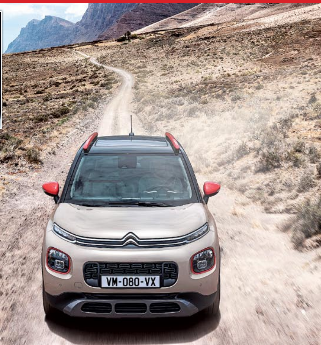
▲▶ El control de descensos Hill Assist Descent se activa con un botón y permite mantener una velocidad baja y constante para bajar pendientes con total seguridad.
