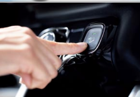
▲▶ El control de descensos Hill Assist Descent se activa con un botón y permite mantener una velocidad baja y constante para bajar pendientes con total seguridad.
