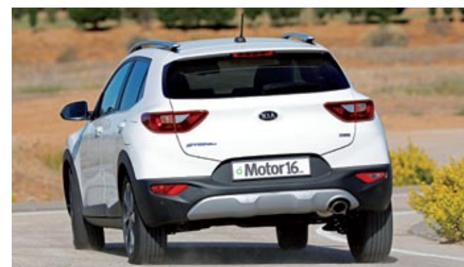
◀ Los 18,3 centímetros de altura al suelo, que permiten circular sin miedo por caminos, no restan eficacia sobre asfalto. Además, la suspensión es más firme que la del Rio para reducir el balanceo, con un resultado óptimo.
