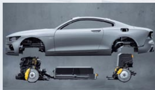
▼▲ El Polestar 1, de 4,5 metros de largo, acoge un motor de gasolina Drive-E de 2 litros bajo el capó –acciona las ruedas delanteras– y dos eléctricos detrás para la tracción trasera, única activa en el modo Pure.
