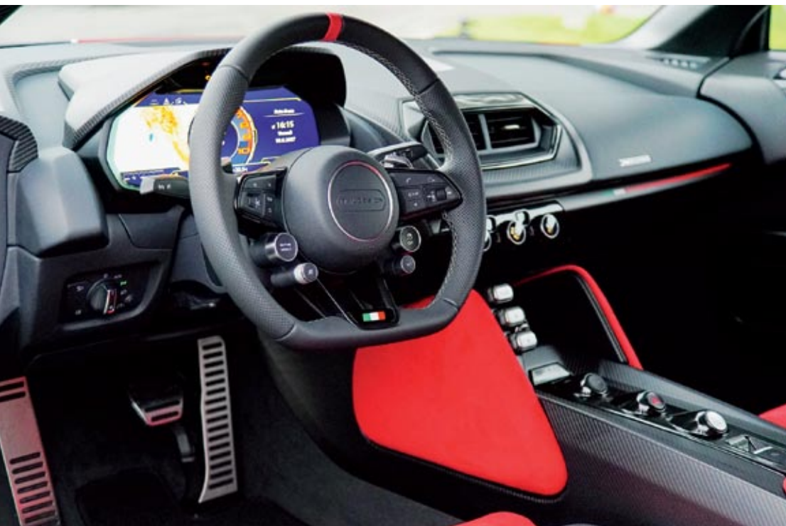
◀ El interior del Zerouno está realizado al completo en fibra de carbono y materiales ligeros. El cambio automático de doble embrague se maneja por levas.
