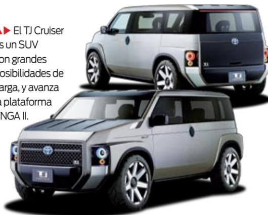
carreras. Además, su transmisión automática puede ser usada manualmente. La otra propuesta es el TJ Cruiser, que combina virtudes de SUV con las de un vehículo de carga. Admite objetos de hasta tres metros de largo, emplea materiales de mayor resistencia en su carrocería y tiene una mecánica híbrida –basada en un 2.0 de gasolina– que se puede asociar a dos tipos de tracción: delantera o total.
