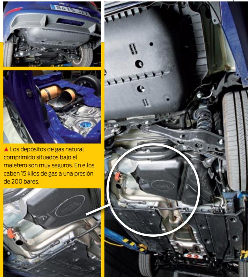
▲ Los depósitos de gas natural comprimido situados bajo el maletero son muy seguros. En ellos caben 15 kilos de gas a una presión de 200 bares.
