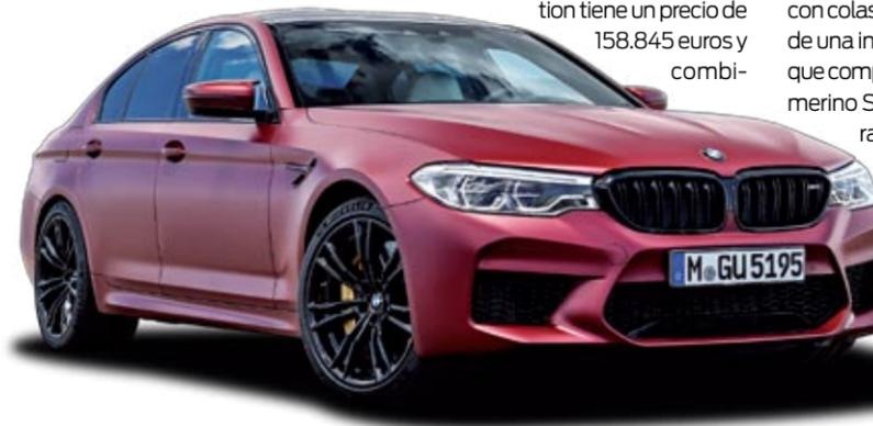
generación del M5, que cuenta con la nueva tracción M xDrive y el motor de 4.4 litros V8 BMW M TwinPower Turbo de 600 CV. Preparado para iniciar las entregas en marzo de 2018, el M5 First Edition tiene un precio de 158.845 euros y combi-
