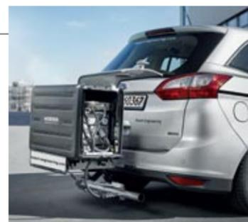
▲ En el ciclo RDE de emisiones los vehículos son equipados con un PEMS (Portable Emissions Measurement System), cuyo uso no se descarta para medir los consumos en un futuro próximo.
