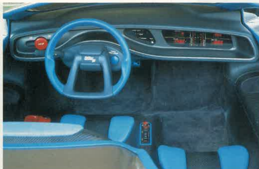
INTERIOR SENCILLO, ESTILIZADO Y COLORISTA El conjunto pedales y volante es móvil para una mejor posición de conducción.
