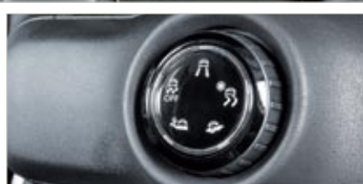
▲ El salpicadero del C4 Cactus está presidido por una pantalla de 7 pulgadas asociada a siete botones sensitivos. La ruleta del Grip Control permite activar cinco modos de conducción.
