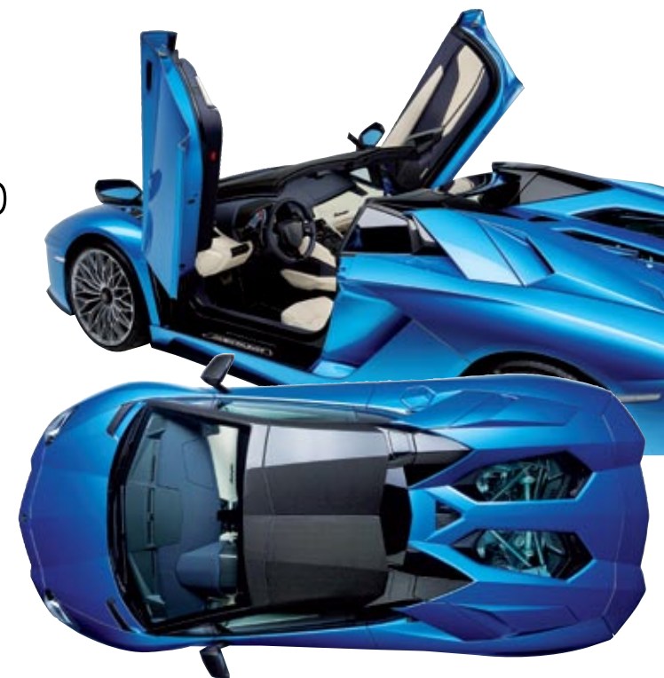
► Como todo 'Lambo' V12, cuenta con este sistema de apertura de puertas. El techo de carbono pesa seis kilos y debe quitarse a mano.
