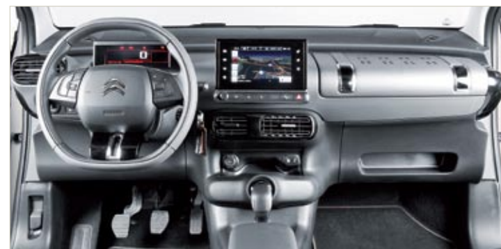
▲ El salpicadero del C4 Cactus está presidido por una pantalla de 7 pulgadas asociada a siete botones sensitivos. La ruleta del Grip Control permite activar cinco modos de conducción.
