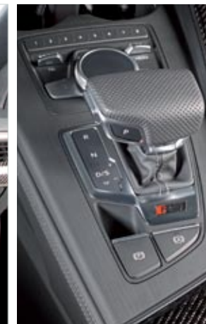
▲ La caja Tiptronic, de 8 marchas, cambia ahora con más rapidez, sobre todo en el modo S. Además, hay 'launch control'.
