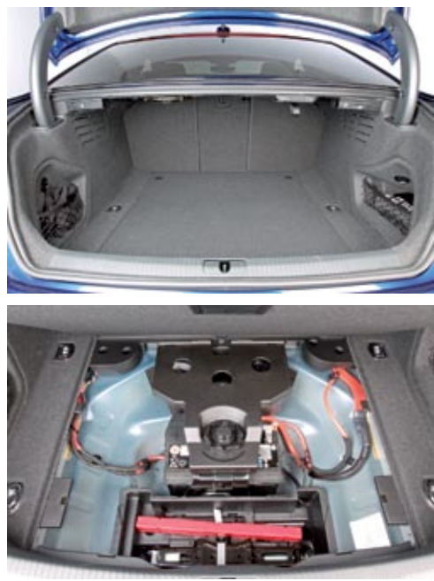
▲ Maletero de 465 litros y, de serie, respaldo abatible 40:20:40. Debajo va la batería y la rueda de repuesto.
