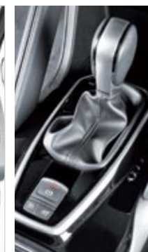
▲ Aunque mejorado, el X-Tronic no iguala al cambio EDC, y no tiene levas en el volante.
