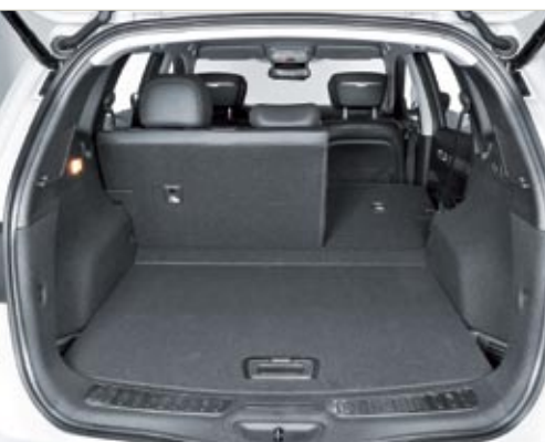
▲ La amplitud interior es sensacional y sus asientos resultan verdaderamente confortables, aunque no haya función masaje en los delanteros. El maletero, de 498 litros, es algo justo, pero llega a 1.706 con dos plazas en uso. De serie hay kit reparapinchazos, y la rueda de emergencia cuesta 99 euros.
