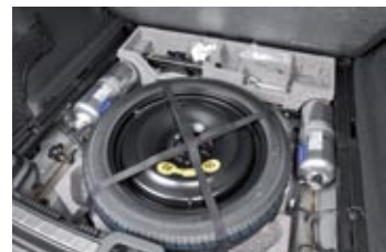
▲ La rueda de repuesto, opcional, reduce en 31 litros el volumen del maletero, que parte de 505 litros.
