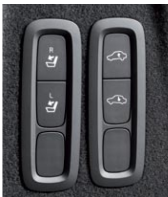
▼▼ Los botones que abaten por secciones el respaldo desde el maletero son un extra, como el portón eléctrico. Y se echa de menos una segunda fila corredera, como la que ofrece el Audi Q5. Pero hay amplitud y un estupendo confort.
