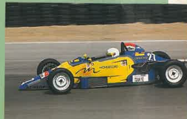
VAN DIEMEN RF 92. Incorpora un monoamortiguador delantero proveniente de la Fórmula 1.
