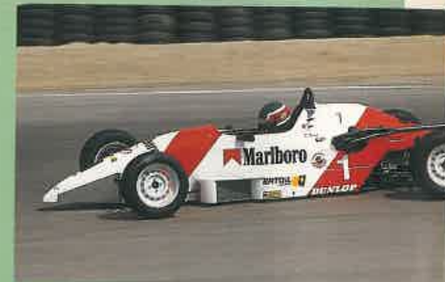
SWIFT SC92F. Mantiene una estructura convencional de doble amortiguador delantero y trasero.
