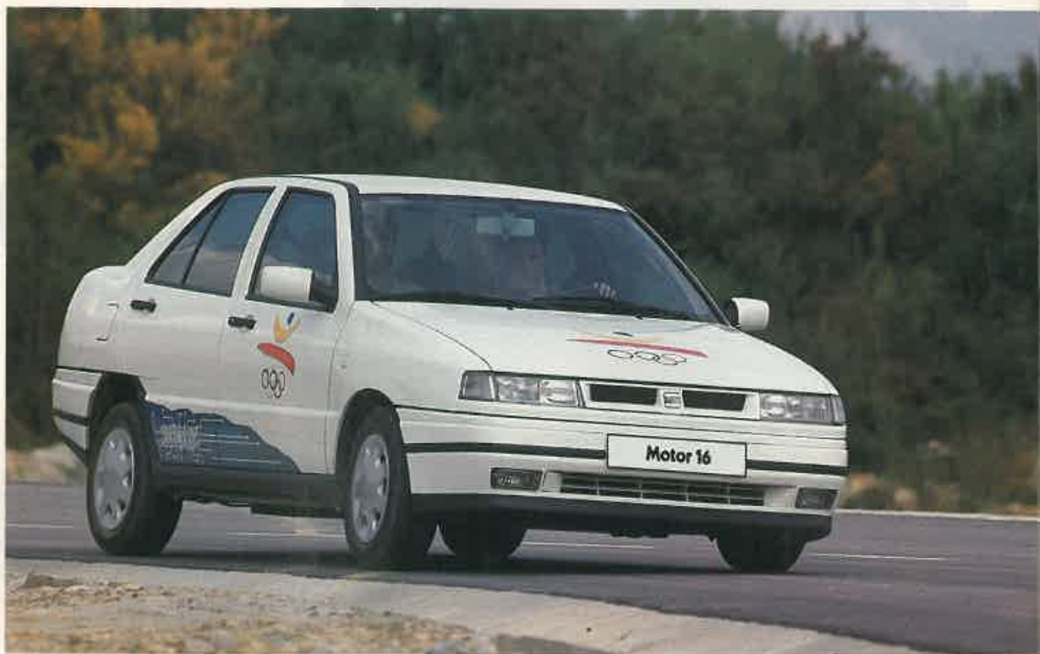
A PLOMO El elevado peso del Toledo Electric se deja notar en el comportamiento dinámico. Las baterías de plomo, sustentadas por el eje trasero, son las culpables
