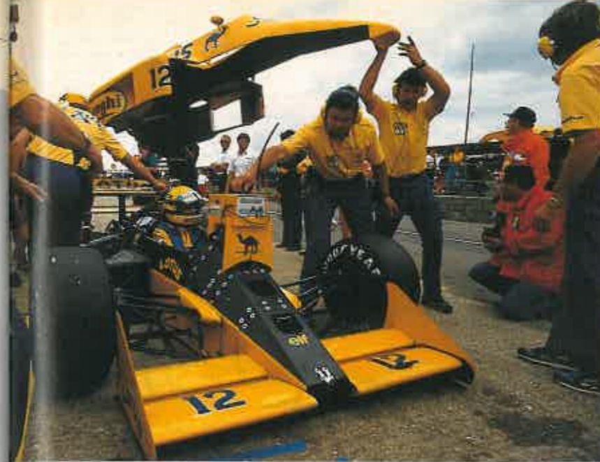
A SENNA LE GUSTABA El sistema de suspensión activa de Lotus permitió a Ayrton Senna adjudicarse la victoria en el Gran Premio de Mónaco y de Detroit en 1987. Los treinta kilos que pesaba todo el mecanismo, no permitieron al Lotus 99 T ser competitivo en los circuitos rápidos.
