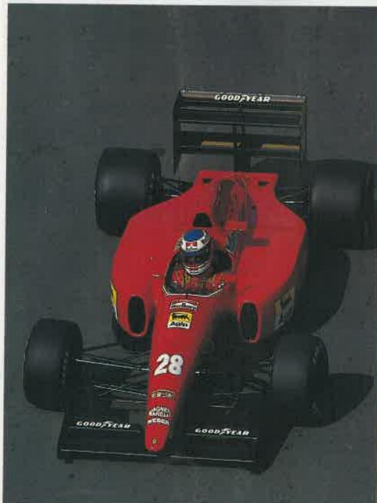
trecientos kilómetros por hora, triplican el peso del monoplaza con piloto incluido. Al mismo tiempo, en un F1, los neumáticos producen un choque aerodinámico que resta un setenta por ciento del factor de penetración aerodinámico que tiene el coche sin ellos.
