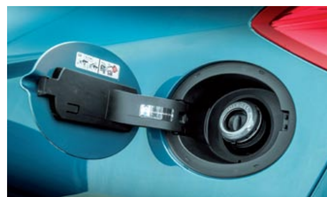
▲ Tecnología práctica: el sistema de repostaje EasyFuel, que prescinde de tapón, reduce las pérdidas al mejorar el diseño del cuello de llenado.
