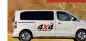
'off-road' con amplitud, versatilidad, equipamiento de confort y los sistemas de ayuda a la conducción más avanzados. Este SpaceTourer de tracción total cuenta con la transmisión Dangel con diferencial de deslizamiento limitado y el 2.0 BlueHDi 150, equipado con cambio manual de seis velocidades.
