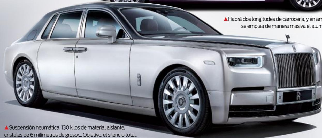
▲ Suspensión neumática, 130 kilos de material aislante, cristales de 6 milímetros de grosor... Objetivo, el silencio total.
