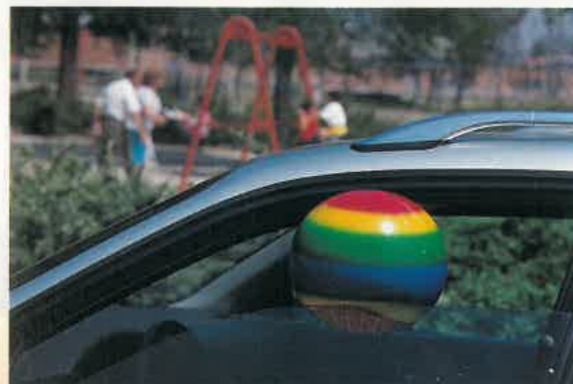
PROHIBIDOS EN USA En Estados Unidos está prohibida la utilización de elevalunas eléctricos que puedan accionarse con un solo toque y no tengan sensor.
