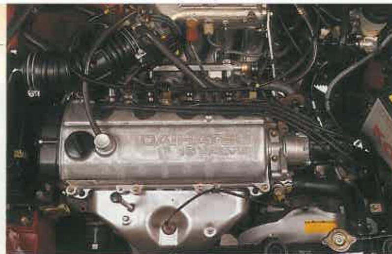
ELASTICIDAD MECÁNICA El compacto motor del Charade TR dispone de una culata de dieciséis válvulas y de inyección electrónica. El resultado son noventa caballos de potencia.
