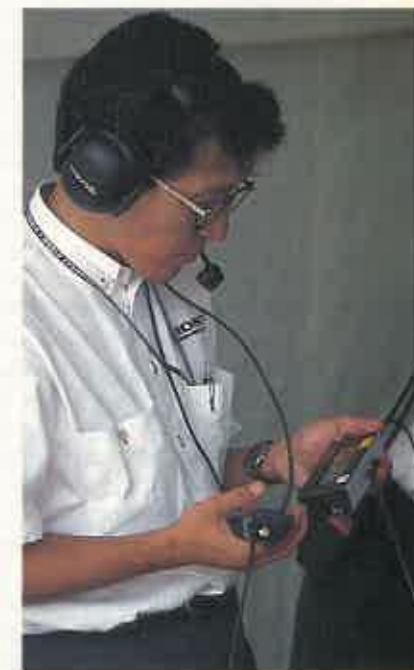
TECNOLOGÍA Un técnico de Honda manipula el acelerador electrónico adicional, y el indicador digital de la respuesta del motor.
