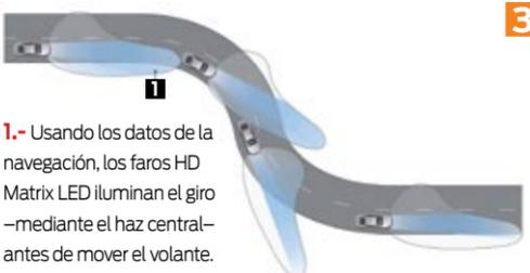
Usando los datos de la navegación, los faros HD Matrix LED iluminan el giro —mediante el haz central— antes de mover el volante.
