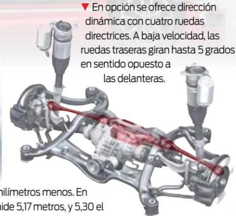
▼ En opción se ofrece dirección dinámica con cuatro ruedas directrices. A baja velocidad, las ruedas traseras giran hasta 5 grados en sentido opuesto a las delanteras.
