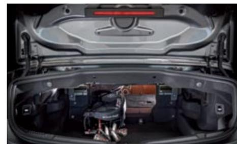
◀ La capacidad del maletero oscila entre los 385 litros y los 310 si llevamos el techo replegado. El respaldo trasero se abate en secciones 50:50.
