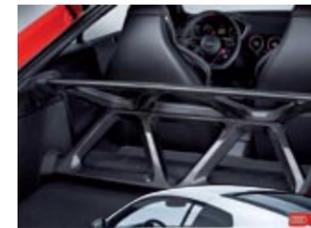
◀ El refuerzo de CFRP para el TT elimina las plazas traseras –ahorra 20 kilos– y mejora la rigidez torsional.
