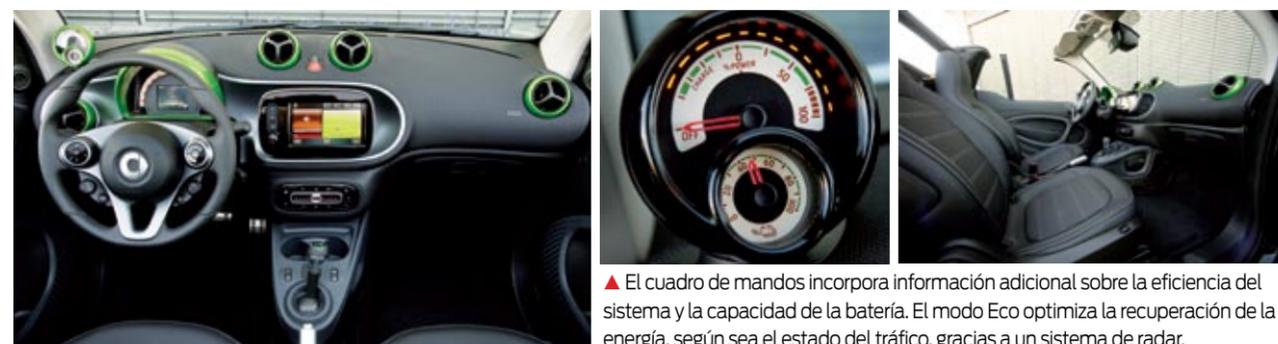
▲ El cuadro de mandos incorpora información adicional sobre la eficiencia del sistema y la capacidad de la batería. El modo Eco optimiza la recuperación de la energía, según sea el estado del tráfico, gracias a un sistema de radar.
