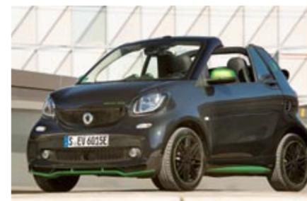
◀ En 12 segundos el techo de lona se repliega, operación que se puede realizar a cualquier velocidad. Los largueros pueden desmontarse manualmente.
