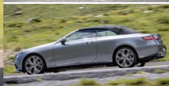
▲▼ La calidad del techo de lona es sobresaliente. Se abre o se cierra en 20 segundos de manera eléctrica, y se puede hacer en marcha hasta los 50 km/h.
