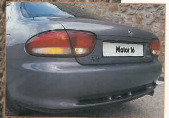
AERODINÁMICA REFINADA Con un Cx de 0,29, el Xedos consigue un buen rendimiento aerodinámico y una total ausencia de ruidos.
