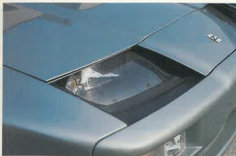
FAROS PECULIARES El sistema de escamoteado de los faros del Bambú no es nada frecuente. Debajo se ocultan unos grupos ópticos elipsoidales.
