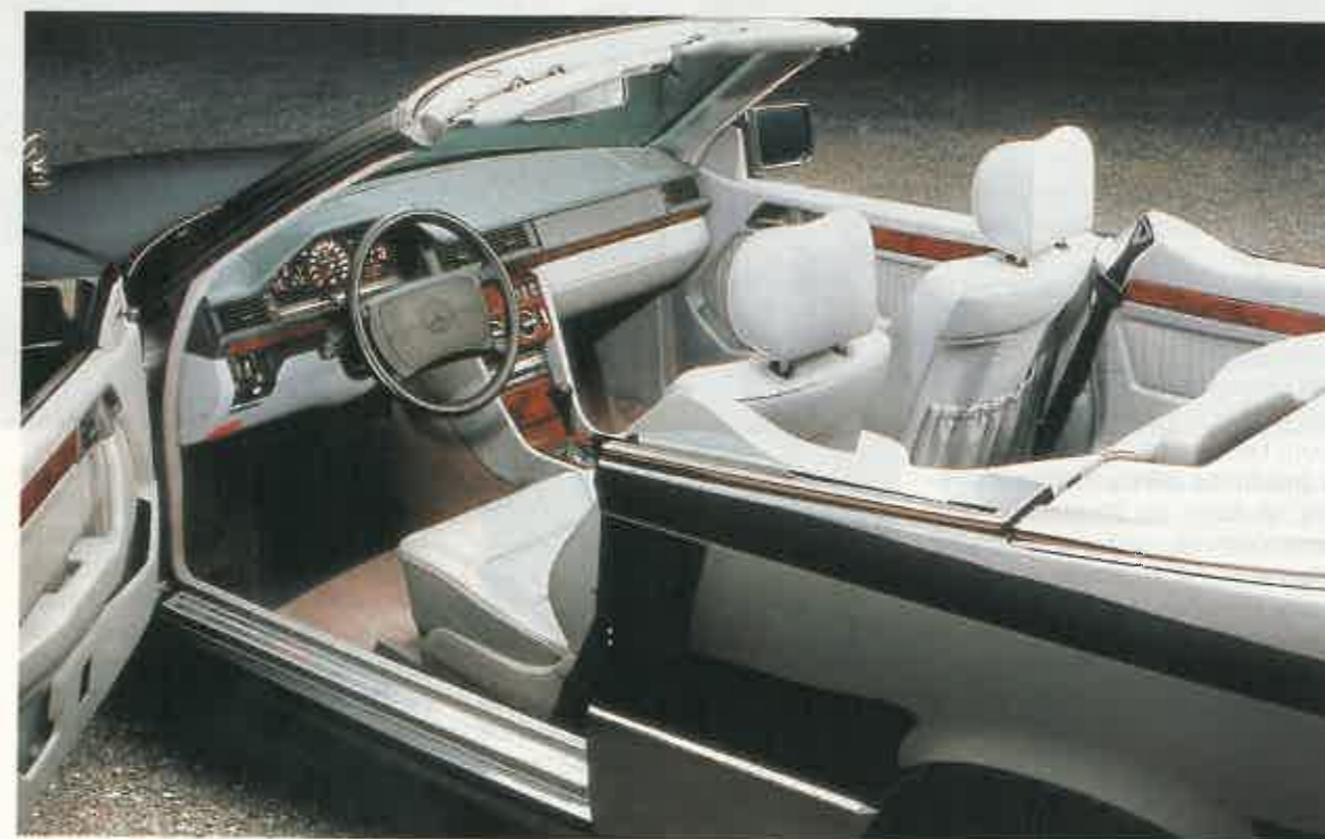
REVISIÓN GENERAL La carrocería del coupé 300 CE ha sido profundamente revisada y reforzada para conseguir la misma rigidez en la versión cabriolet. Más de mil piezas han sido diseñadas de nuevo.
