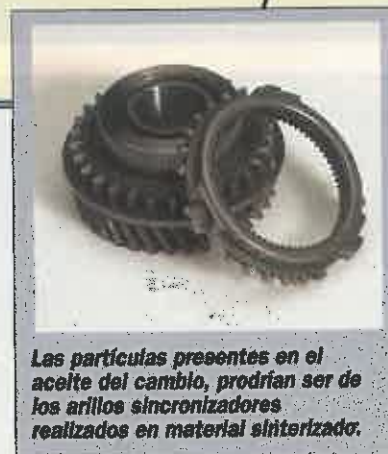
En la caja de cambios, una vez desmontada, se pudo observar que el desgaste de todos sus elementos era normal.
