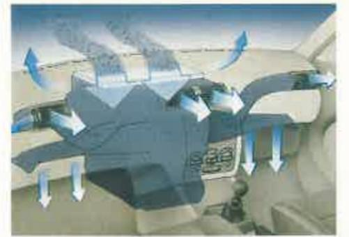
De serie, ventilación con Sistema Microfiltro que proporciona aire desprovisto de polvo, humos o polen.
