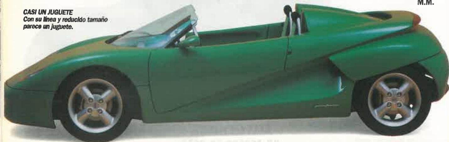
una resistencia muy similar. Con todo esto y la carrocería, que está hecha con paneles de plástico sujetos con pegamento, el peso total del coche es de 700 kilos.
