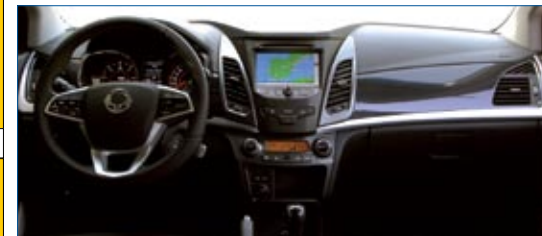
▲ El volante del Korando es nuevo, y también los relojes que hay tras él. En cuanto a seguridad, el nuevo modelo no monta el sistema SASS de sus hermanos pequeños, pero lleva seis airbag y un completo paquete ESP.
