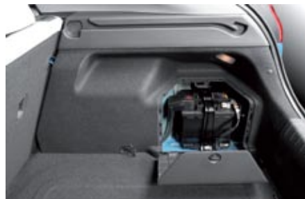
▲ La batería principal va debajo de las plazas traseras; y la de accesorios, en un lateral del maletero. Eso libera 550 litros para el equipaje.
