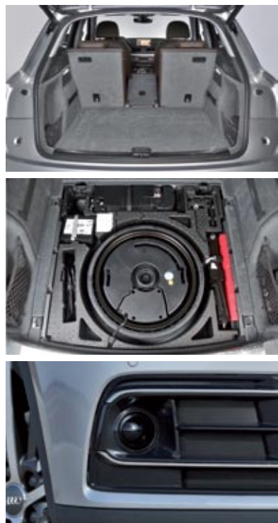
▲ Sobre estas líneas, un radar frontal. Y más arriba, el maletero –hasta 610 litros con cinco plazas– y la 'rueda' de repuesto.
