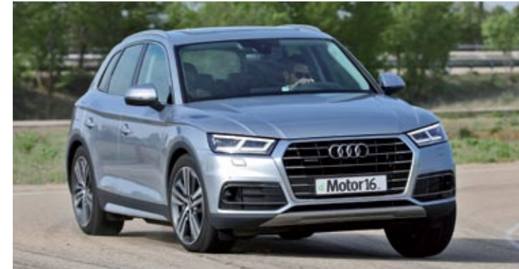
▲ La versión Design implica neumáticos 235/60 R18 en vez de los 235/65 R17 del nivel básico. Pero nuestro Q5 calzaba unos 255/45 R20.
