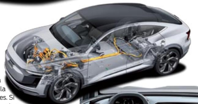
►Las baterías van bajo el suelo y hay tres motores: uno delante y dos detrás. El maletero cubica 550 litros.
