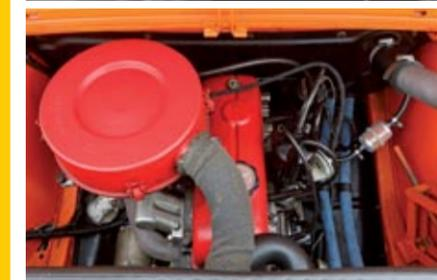
▲▼ Los mayores contrastes los encontramos en los motores. Un 4 cilindros 1.1 de 56 CV con carburador de doble cuerpo en el R8 TS frente a un V8 de 605 CV, inyección directa y turbo en el S8 Plus. Pero lo curioso es que gasta más el TS.
