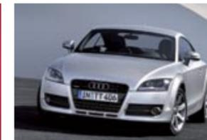
▲ La segunda generación del TT estrenó una carrocería ASF de aluminio y acero: 90 kilos menos.
