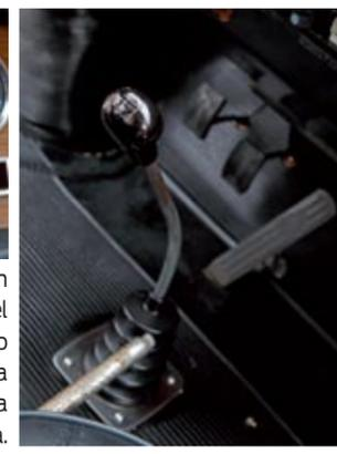
▲▶ Los pedales del R8 TS están muy desplazados a la derecha por el prominente paso de rueda. Eso, junto con la posición de la palanca, obliga a adoptar una posición de la pierna derecha muy forzada.
