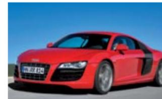
▲ Para el R8 de 2007 se usó aluminio, magnesio y fibra de carbono. La carrocería pesaba solo 206 kilos.
