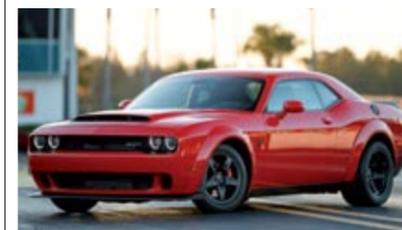
**DODGE CHALLENGER SRT DEMON.**- Sus antecesores, los Charger y Challenger SRT Hellcat, se quedaron en 707 CV, pero la nueva 'criatura' saca 840 CV del 6.2 Hemi Demon V8: de 0 a 48 km/h en un segundo, y de 0 a 96 en 2,3 segundos.
