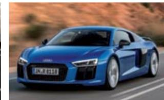
▲ Con aluminio y muchas piezas de fibra de carbono, la carrocería del último R8 pesa solo 200 kilos.
