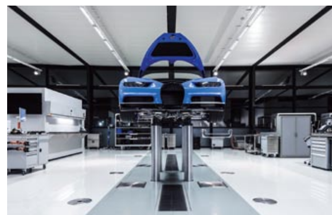
▲ Estas columnas soportan cada ejemplar de Bugatti Chiron durante su fabricación. La cadena de montaje, realmente, brilla por su ausencia.
