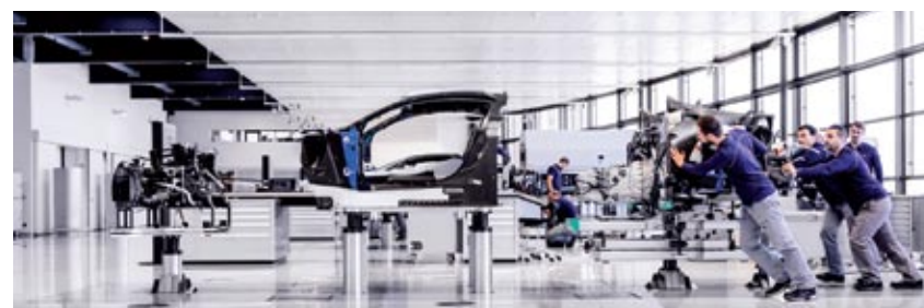
◀ El chasis monocasco está fabricado en carbono y se ensambla con su corazón mediante sólo 14 tornillos de titanio. Cada uno de ellos pesa 14 gramos.
