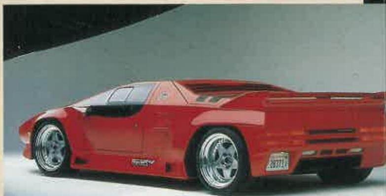
**POR CABALLOS QUE NO QUEDE** El motor V-8 del Vector Avtech WX-3, de siete litros de cilindrada, tiene una potencia que puede llegar al máximo de rendimiento, con los dos turbos a tope a 1.200 caballos. Lógicamente, las prestaciones son de vértigo: 400 kilómetros por hora de velocidad máxima lo dice todo.
